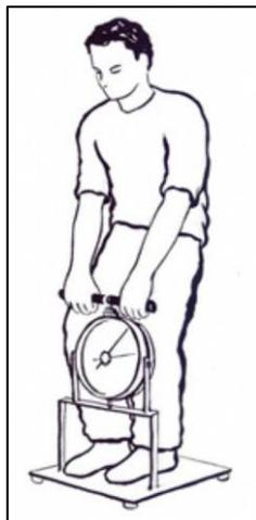
**Figura 21** - Dinamômetro Dorsal - Marca Crown.
