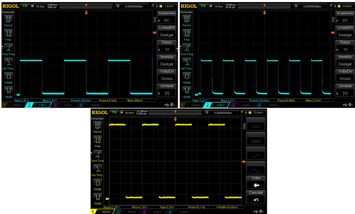
Figura 5.5: Sinais de controlo provenientes do microcontrolador. Na figura à esquerda o sinal de controlo de 5kHz, na figura à direita o sinal de controlo de 50kHz e na figura em baixo o sinal de controlo de 16Hz.
