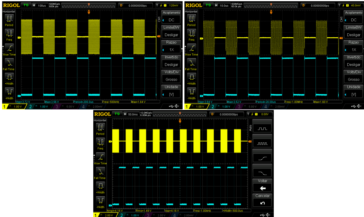
Figura 5.6: Resposta do circuito de corte face aos sinais de controlo, CH2 (azul), mencionados anteriormente. Na figura à esquerda a comutação do circuito com o sinal de controlo de 5kHz, na figura à direita a comutação do circuito com o sinal de controlo de 50kHz e na figura em baixo a comutação do circuito com o sinal de controlo de 16Hz.
