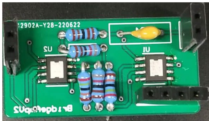
Figura 4.9: Circuito impresso do circuito de amplificação com o OPAMP THS3491.
