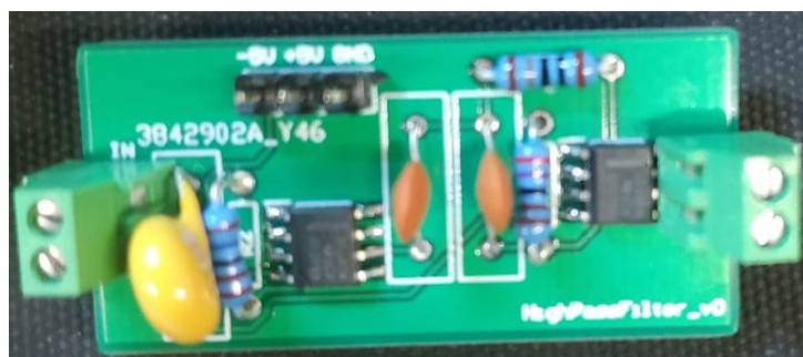
Figura 4.19: PCB do circuito do filtro passa-alto com frequência de corte de 500kHz utilizando o OPAMP OPA828
