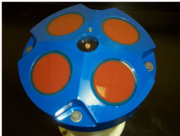
Figura 2.11: ADCP com 4 transdutores[6].
