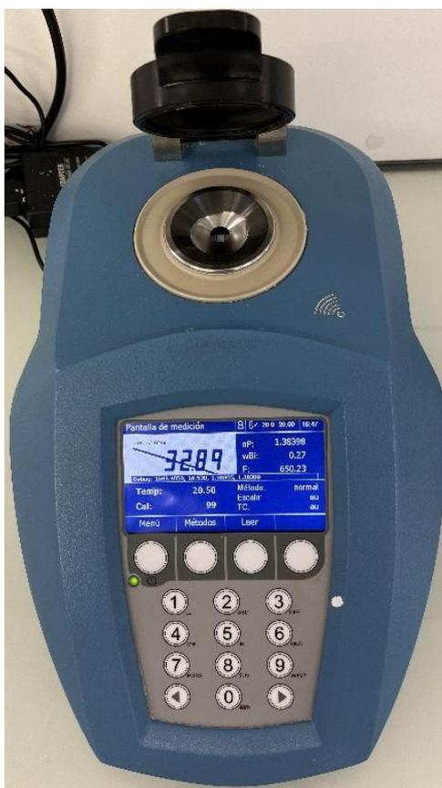
**Figura 5.** Refratômetro usado para a determinação da concentração de ureia pelo índice de refração. Refratômetro utilizado no trabalho prático, com as especificações descritas na norma ISO 22241-2<sup>4</sup> e apresentação do valor da concentração da ureia.
