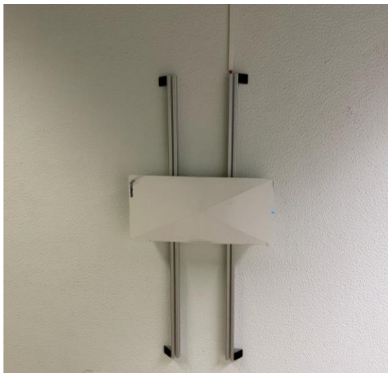
Figura 31- Pórticos deteção de tags do sistema RFID do Serviço de Logística.
