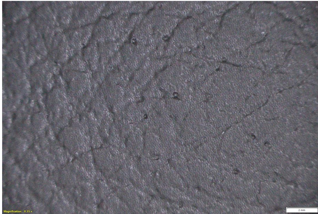
Figura 88 - Micrografia do artigo D gravado a 235°C após 48 horas da gravação.
