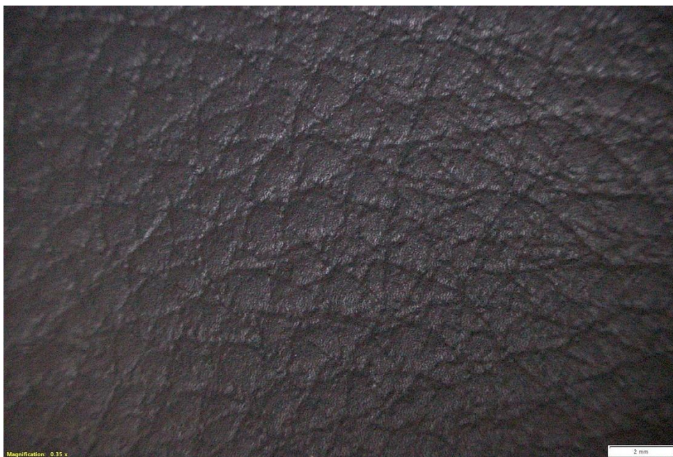
Figura 80 - Micrografia do artigo C gravado a 235° C, 24 horas após a gravação.
