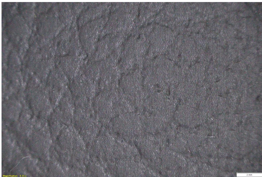
Figura 87 - Micrografia do artigo C gravado a 235°C após 48 horas da gravação.
