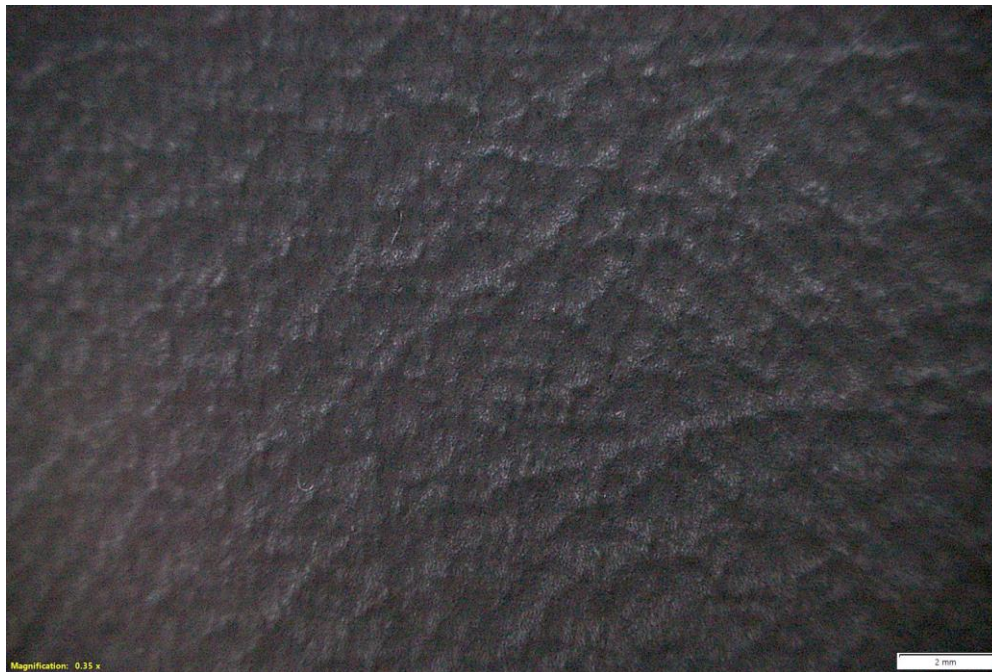
Figura 83 - Micrografia do artigo F gravado a 235°C, 24 horas após a gravação.
