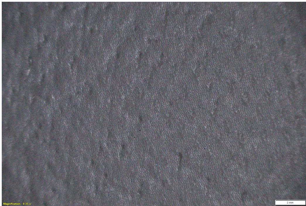
Figura 90 - Micrografia do artigo F gravado a 235°C após 48 horas da gravação.
