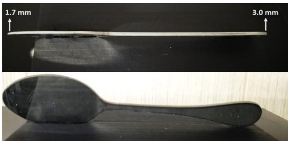
Figura 30: Representação da redução de espessura obtida
