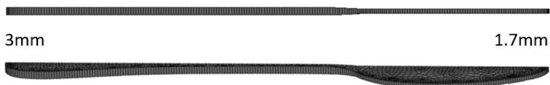
Figura 53: Representação da redução de espessura do esboço
