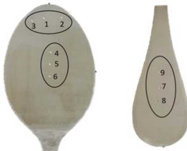
Figura 35: Pontos de leitura da dureza em HRC
