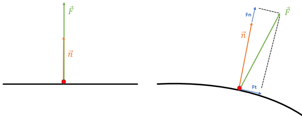
Figura 93: Demonstração das posições da força em relação à normal da chapa na simulação do rameado e da colher, respetivamente
