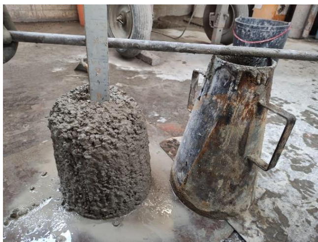
Figura 24 – Ensaio de abaixamento (Slump).
