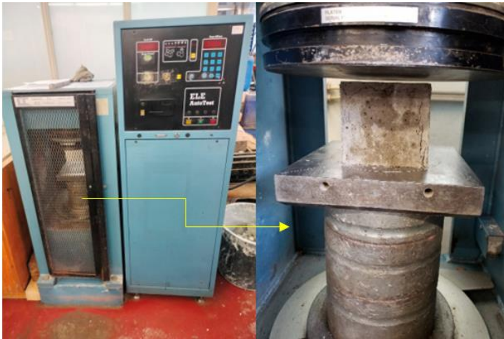
Figura 25 – Prensa para ensaio de resistência à compressão.
