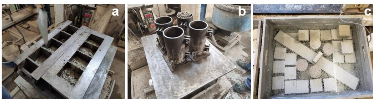
Figura 23 – Moldagem (a), compactação (b) e cura (c).
