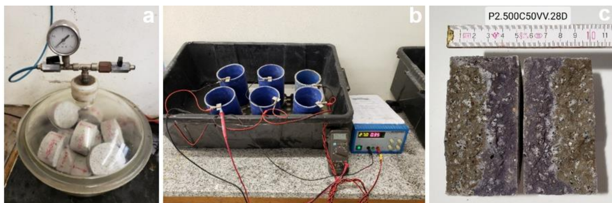
Figura 29 – Câmara de vácuo (a), ensaio em execução (b) e medição dos resultados (c).
