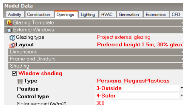
Figura 49 - Printscreens do DesignBuilder , com detalhe na definição do dispositivo de proteção solar, através da secção “Shading” ao nível do edifício
