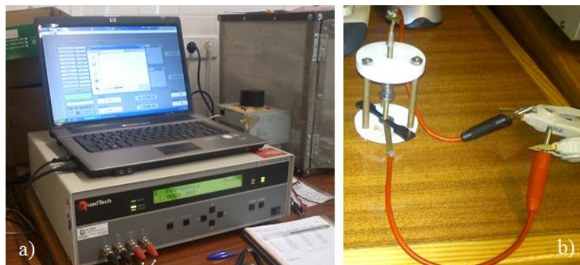
Figura 24 - a) Equipamento utilizado para medir a resistividade elétrica; b) montagem do circuito
