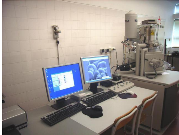
Figura 23 - Equipamento utilizado para a análise microscópica por SEM
