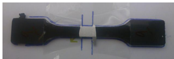
Figura 25 - Representação da montagem para aplicar a laca de prata
