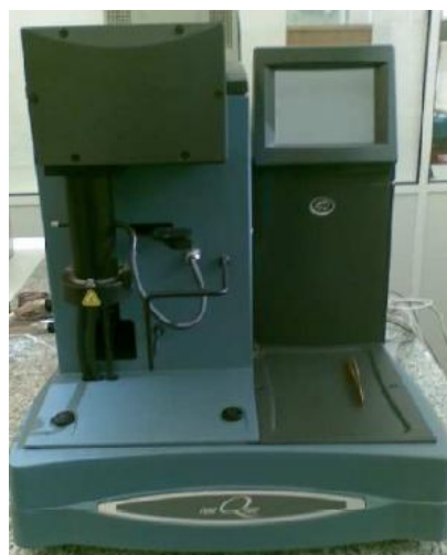
Figura 18 - Equipamento utilizado para o ensaio de TGA.
