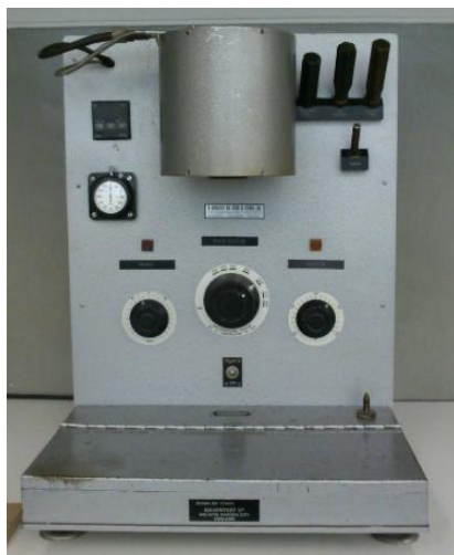
Figura 19 - MFI utilizado para determinar IF dos materiais.
