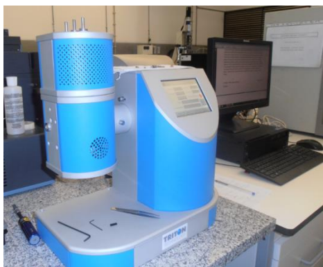
Figura 21 - Equipamento de DMA utilizado para determinar as propriedades termomecânicas dos nanocompósitos.
