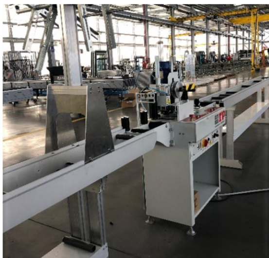
Figura 23 - Equipamento de inserção de vedante e Fresadora de Cópia, respetivamente
