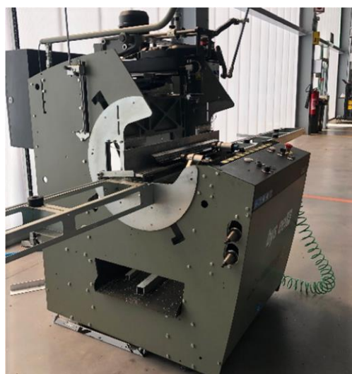
Figura 23 - Equipamento de inserção de vedante e Fresadora de Cópia, respetivamente
