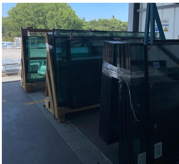
Figura 44 - Vidros em cavaletes para inspeção
