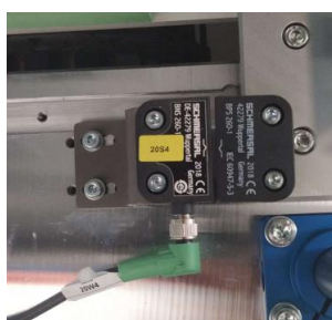
Figura 37 – Sensor de segurança magnético nas gavetas e portas de operação.
