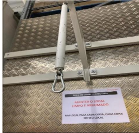
Figura 50. Braço pendular do Sistema para Troca de Manta térmica. Imagens captadas no Bom Dia Queluz Paiva Couceiro, março 2022.
