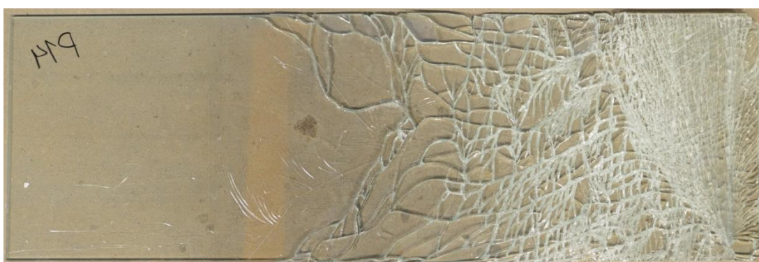
Figura 106 – Padrão de fendilhação após rotura do provete P14.
