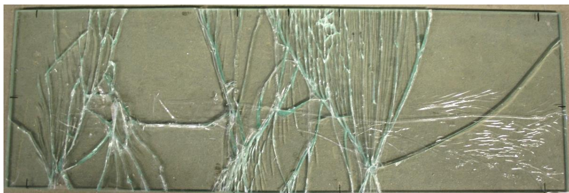
Figura 91 – Padrão de fendilhação após rotura do provete P9.
