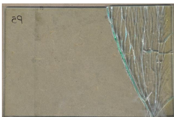
Figura 99 – Padrão de fendilhação após rotura do provete P5.
