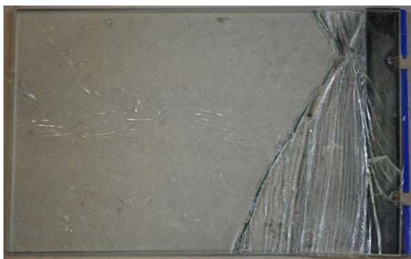
Figura 95 – Padrão de fendilhação após rotura do provete P1.
