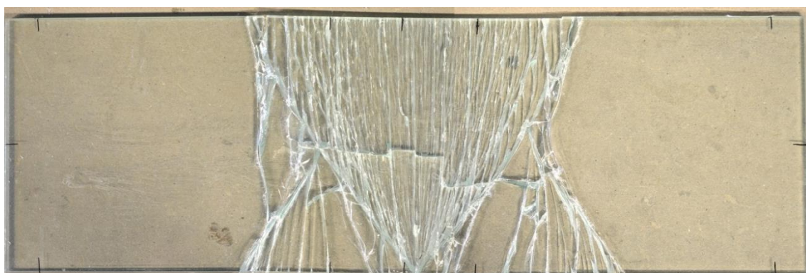
Figura 93 – Padrão de fendilhação após rotura do provete P11.
