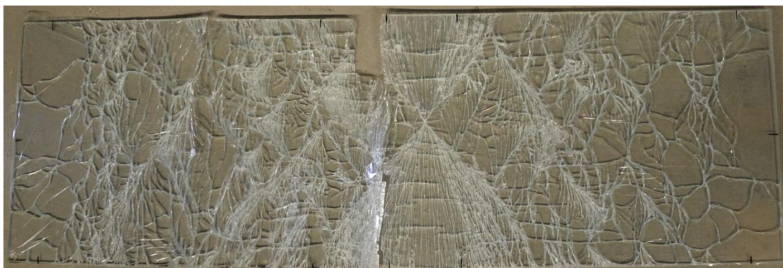
Figura 83 – Padrão de fendilhação após rotura do provete P1.
