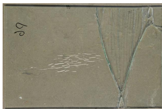
Figura 100 – Padrão de fendilhação após rotura do provete P6.
