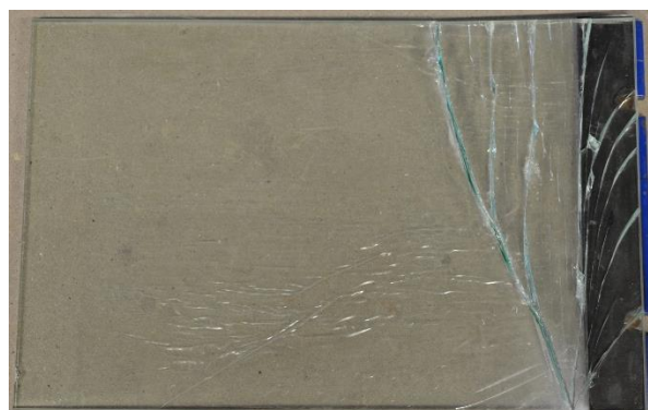
Figura 98 – Padrão de fendilhação após rotura do provete P4.
