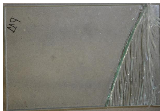
Figura 104 – Padrão de fendilhação após rotura do provete P8.
