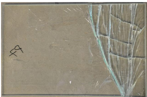
Figura 101 – Padrão de fendilhação após rotura do provete P7.
