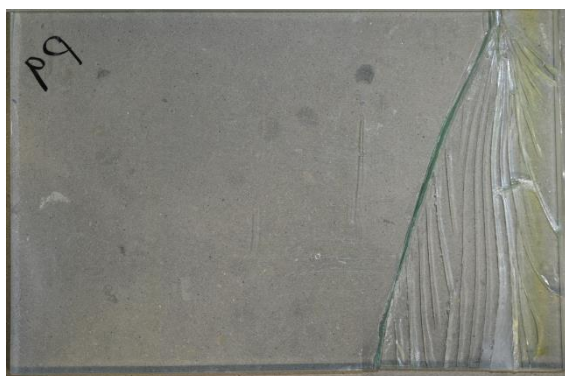
Figura 103 – Padrão de fendilhação após rotura do provete P7.
