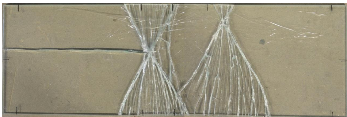
Figura 94 – Padrão de fendilhação após rotura do provete P12.
