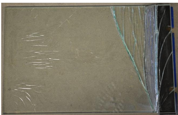
Figura 97 – Padrão de fendilhação após rotura do provete P3.
