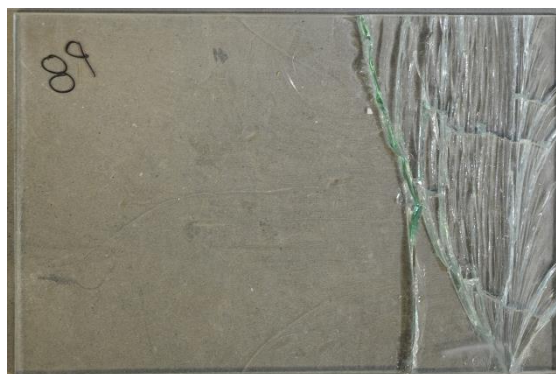
Figura 102 – Padrão de fendilhação após rotura do provete P8.
