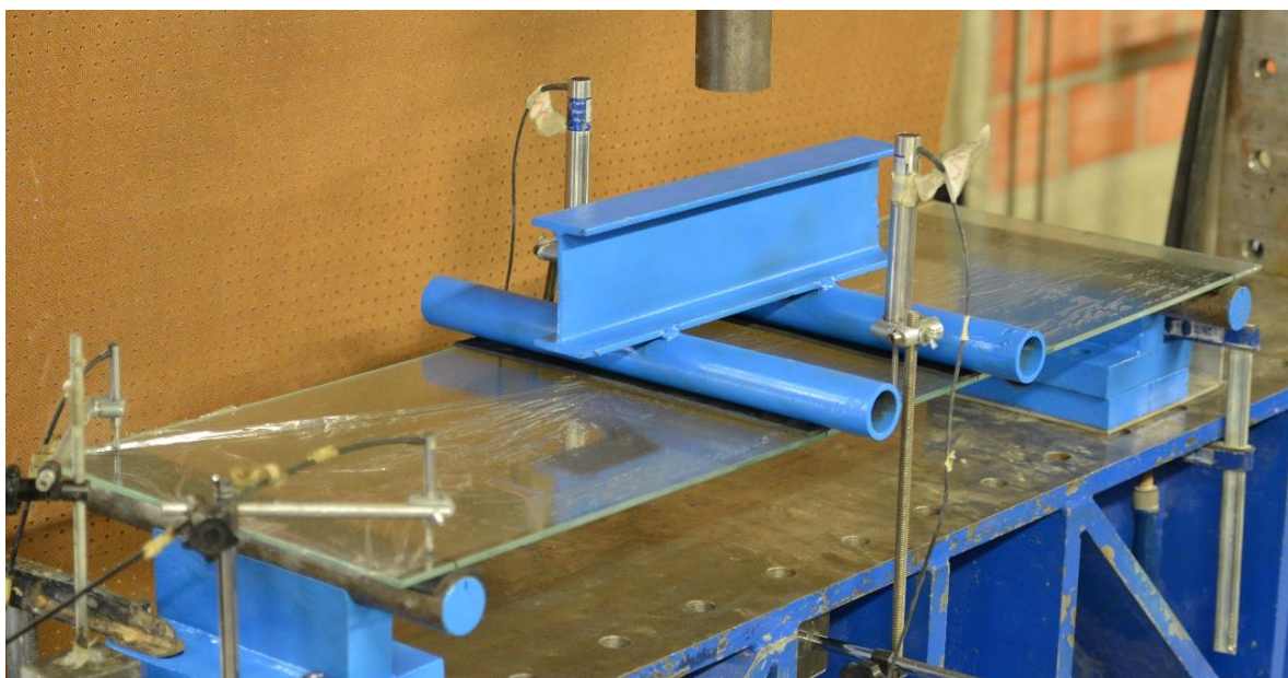
Figura 27 - Esquema de montagem do modelo simplesmente apoiado.
