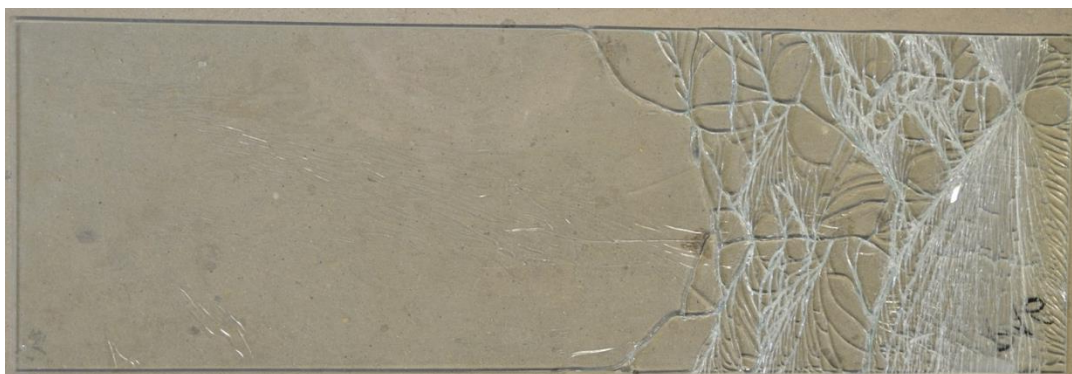
Figura 108 – Padrão de fendilhação após rotura do provete P16.
