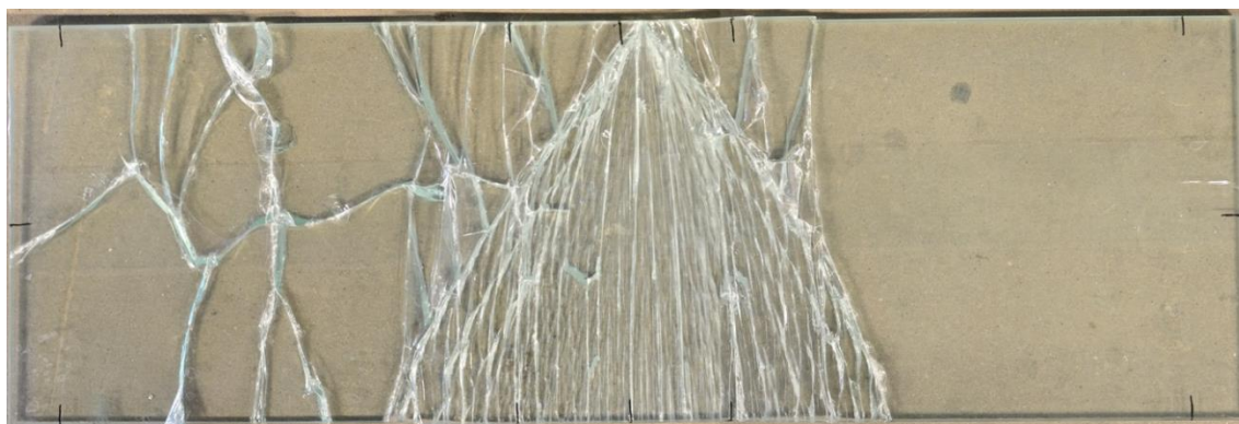
Figura 92 – Padrão de fendilhação após rotura do provete P10.
