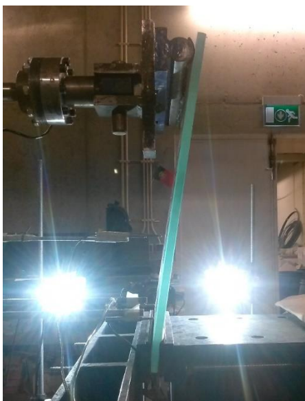
Figura 42 – Rotação excessiva do provete sem ocorrer rotura.
