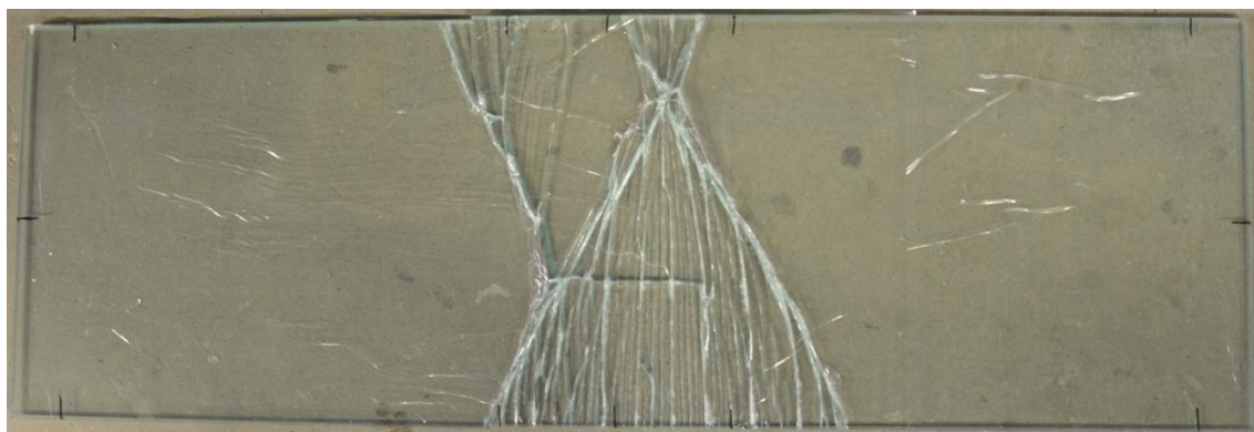
Figura 89 – Padrão de fendilhação após rotura do provete P7.
