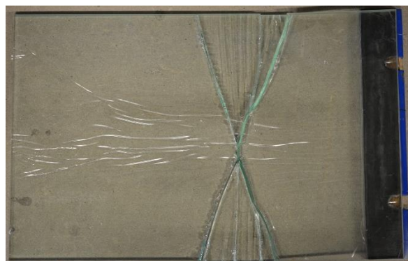
Figura 96 – Padrão de fendilhação após rotura do provete P2.
