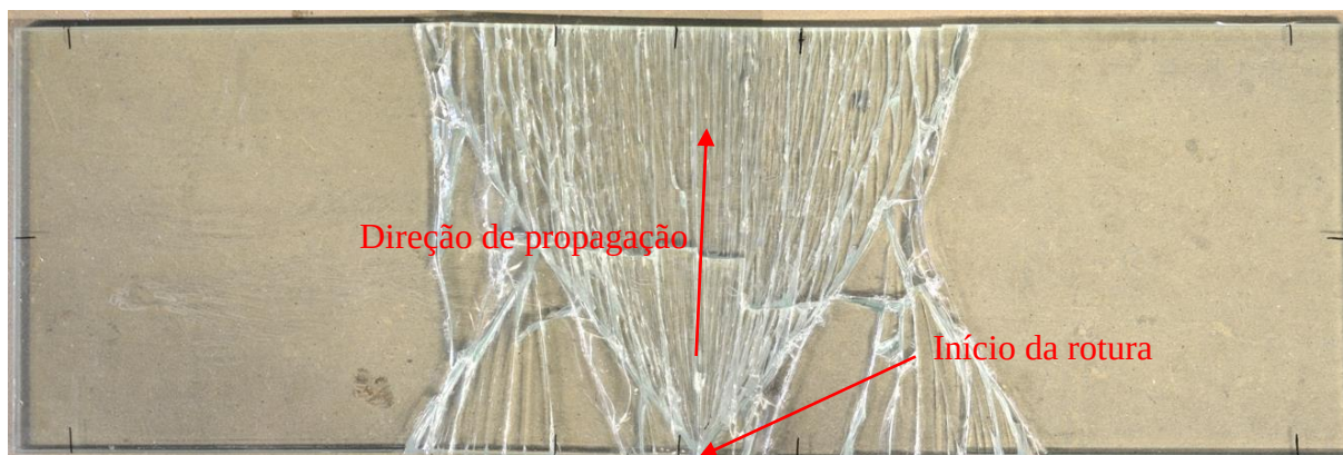
Figura 32 – Padrão de rotura de um provete de vidro recozido.
