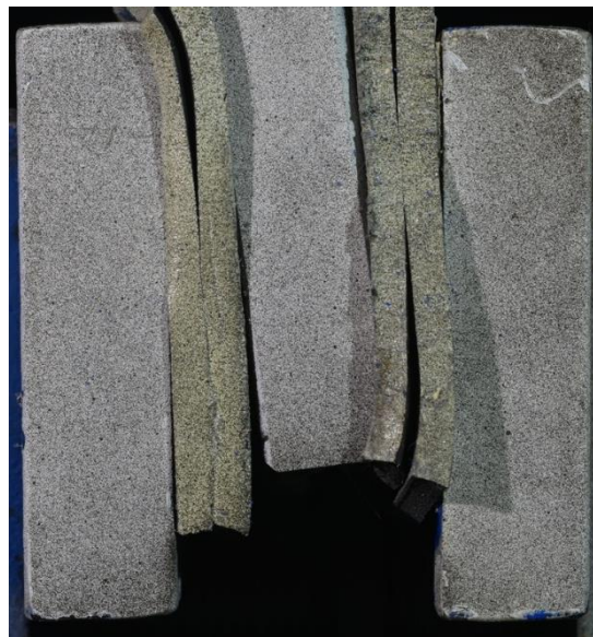
Figura 43 – Rotação excessiva do provete na zona da fixação.
