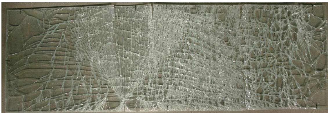
Figura 86 – Padrão de fendilhação após rotura do provete P4.
