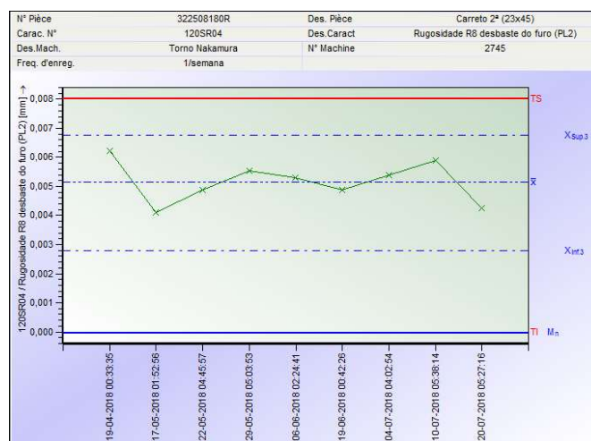
Figura 38 - Detalhes de registos de controlo da característica 120SR04 para o componente PL2 a
