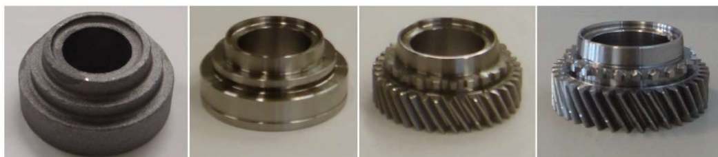
Figura 16 - Componente PL3ª em diferentes estados do processo produtivo e bruto (da esquerda para a direita: bruto, peça após OP120, peça após OP140, peça acabada branca)
