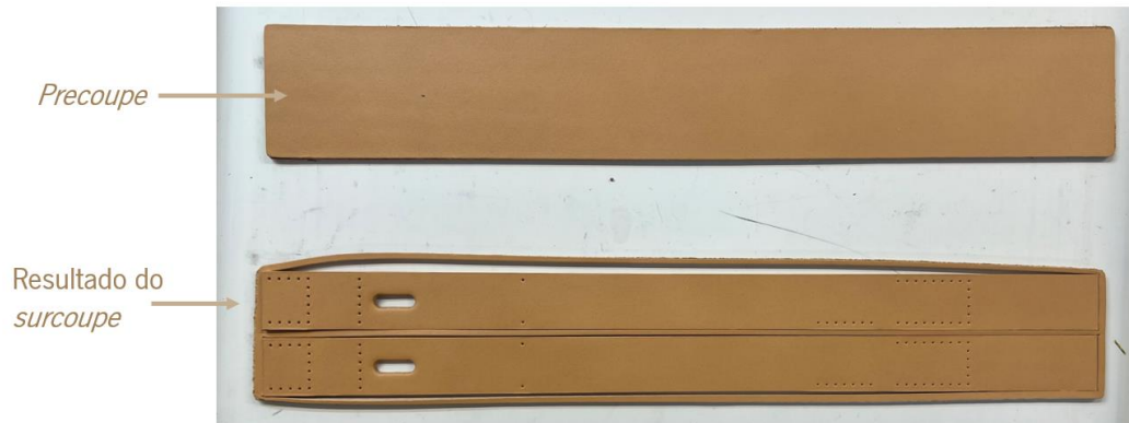
Figura 15 - Exemplo de um precoupe e do resultado do surcoupe
