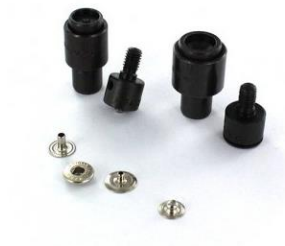
Figura 23 - Exemplo de um jogo de cravação e respetivas metálicas
