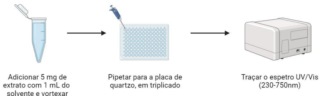
Figura 21. Esquema ilustrativo do procedimento para traçar os espectros UV-vis (as imagens foram obtidas através do software BioRender).
