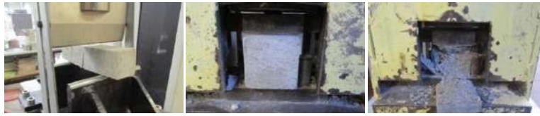
Figura 2. Teste para obtenção das resistências mecânicas das argamassas em estudo.
