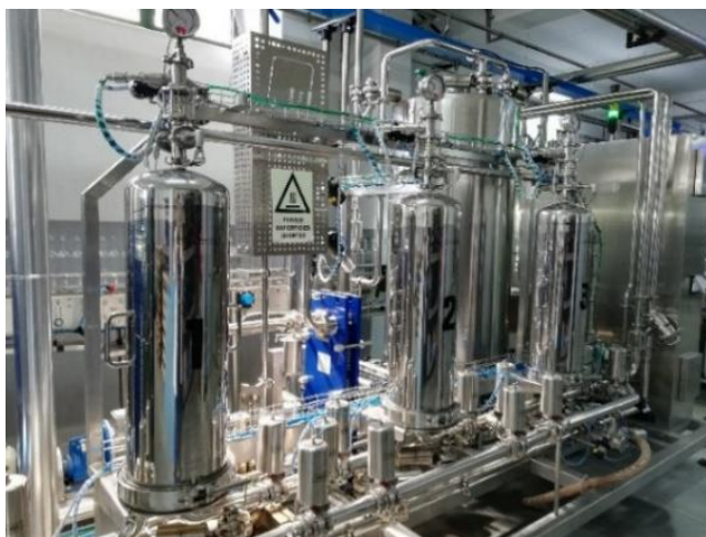
Figura 7 – Bateria de filtros de membranas, com porosidades de 1,2 \mu\text{m} , 0,65 \mu\text{m} e 0,45 \mu\text{m} , respetivamente.
