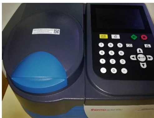
Figura 16 – Espectrofotómetro UV-Vis, da marca Thermo Scientific , modelo Genesys 30 .
