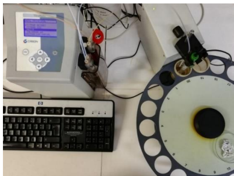
Figura 17 – Titulador potenciométrico da marca Crison , modelo Titro Matic .
