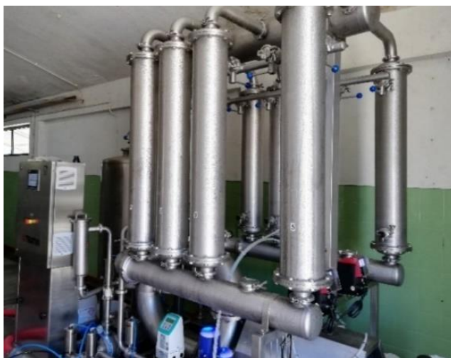
Figura 6 – Filtro tangencial, com membranas de 0,2 µm.
