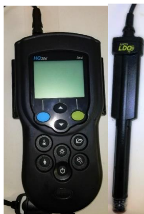
Figura 14 – Medidor HQ30d e sonda Intellica /LDO 101.
