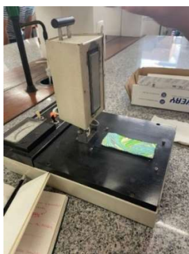
Figura 58 - Submissão do tecido de acordo com a norma de prensagem a quente
