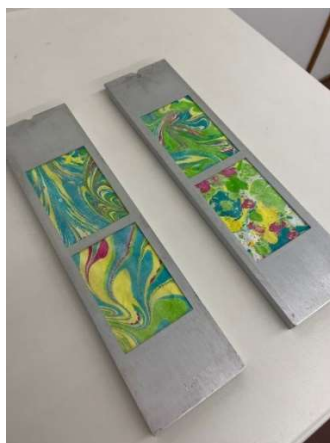
Figura 59 - Disposição dos tecidos para a concretização da norma corresponde à resistência dos raios UV
