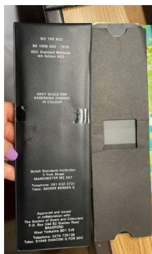
Figura 61 - Teste de solidez da cor que avalia a escala de cinza de mudança na cor
