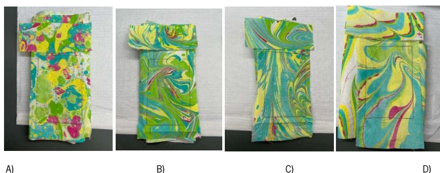
Figura 68 - Tecidos após serem submetidos ao teste de solidez às Lâmpadas fluorescentes UV
