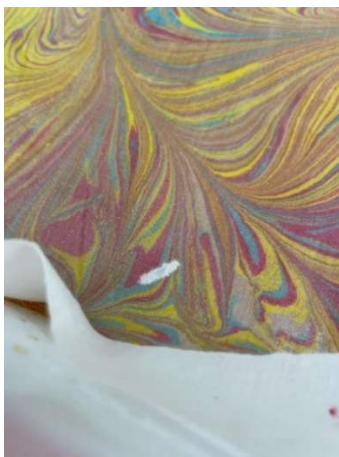
Figura 44 - Bolhas de ar presentes no tecido na fase de transferência
