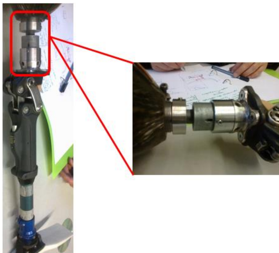
Figura 24 - Representação dos adaptadores concebidos e da sua localização no sistema protésico.
