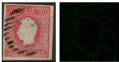
Figura 10 – Mapeamento, por XRF, de mercúrio (Hg) no selo postal 22_1866_Rep1.
