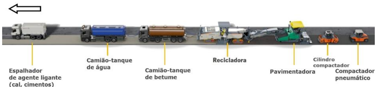
Figura 16 – Composição de um comboio de reciclagem a frio in situ com betume-espuma (adaptado de WIRTGEN, 2024)
