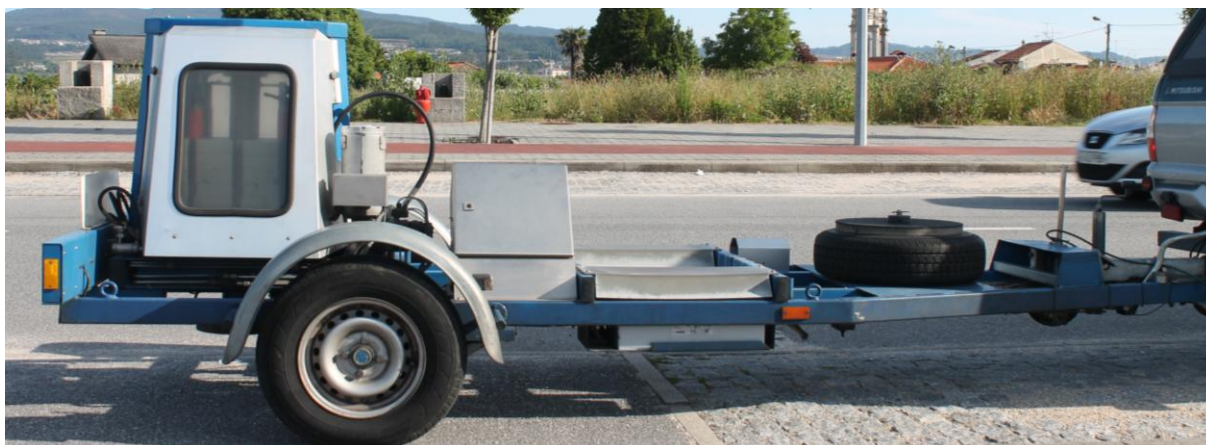
Figura 23 – Defletómetro de impacto (FWD) - Dynatest 8000
