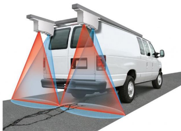
Figura 10 – Sistema de Medição de Fendas a Laser (TII, 2020)
