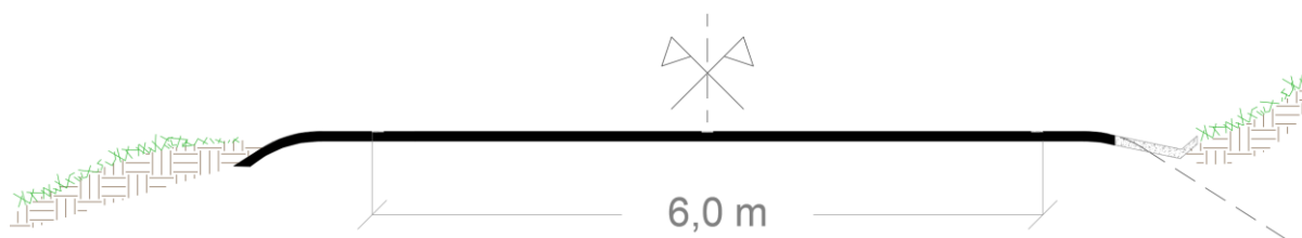
Figura 21 – Perfil transversal tipo de Estradas Nacionais de 3ª classe (adaptado de MOPC, 1945)
