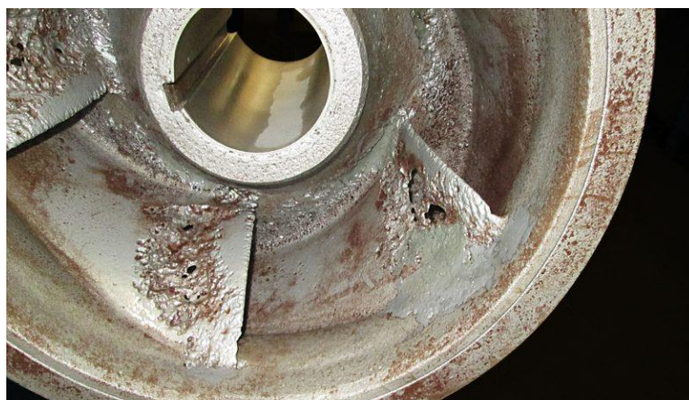
Figura 7: Fenómeno de cavitação nas pás de uma bomba (Fonte: Rodelta)
