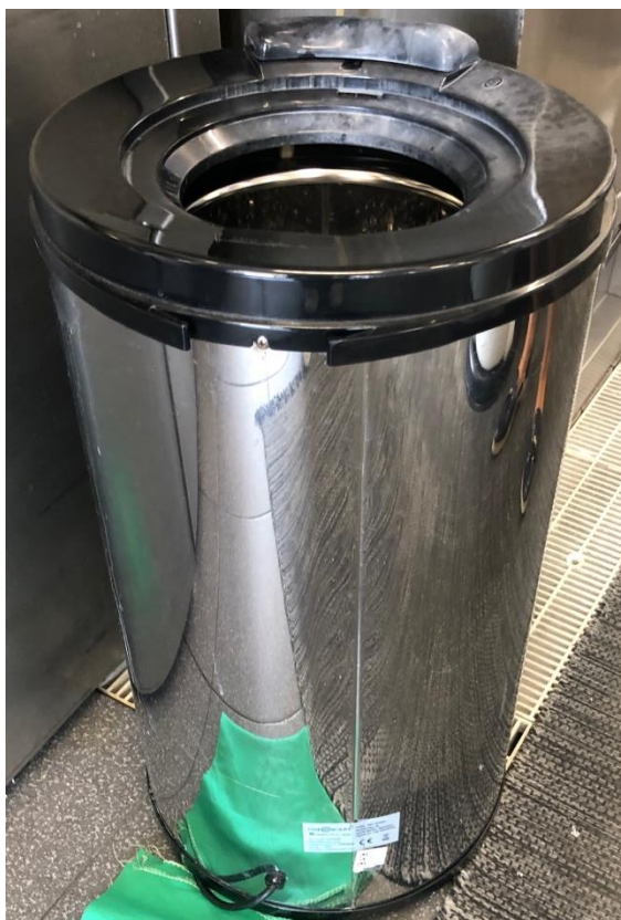
Figura 31 - Equipamento designado como hidro que retira a água em excesso, por rotação, dos ensaios de cor.
