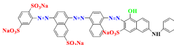
Figura 16 - Estrutura química do corante Triazo Direct Blue 78 [14]
