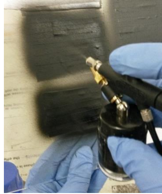
Figura 3.23 Impressão por spray da tinta piezoresistiva de MWCNT/PVA/H 2 O (6 %) do sensor piezoresistivo desenvolvido.
