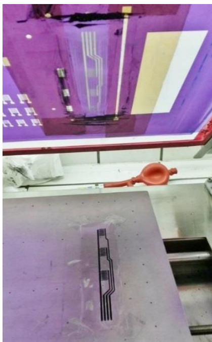
Figura 3.27 Impressão por serigrafia da tinta condutora de MWCNT/SEBS/CPME (15 %) do sensor piezoresistivo desenvolvido.
