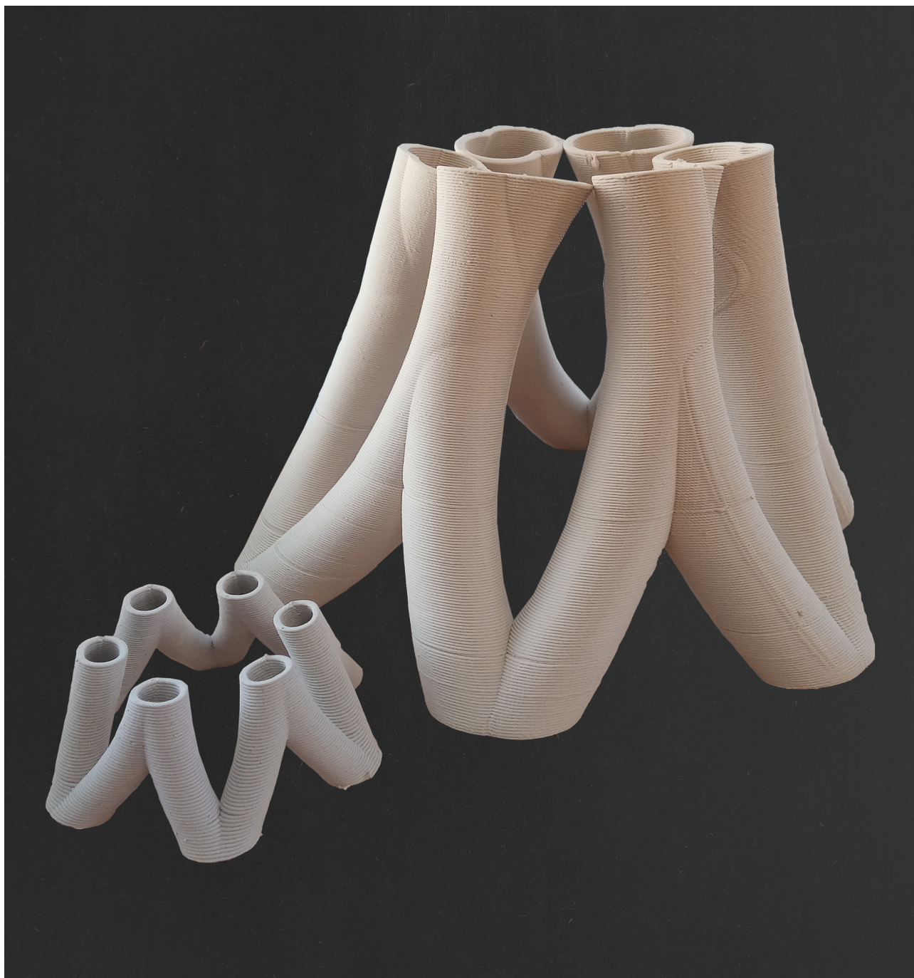
Anexo 8 - Impressão de uma das partes do protótipo final, à escala 1:5 (à esquerda) e à escala 1:2 (à direita).
