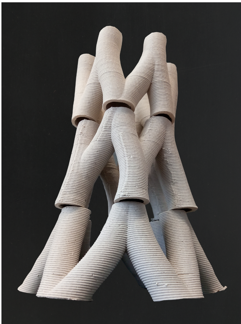
Figura 4.3.i. - Primeiro teste de montagem das peças.
