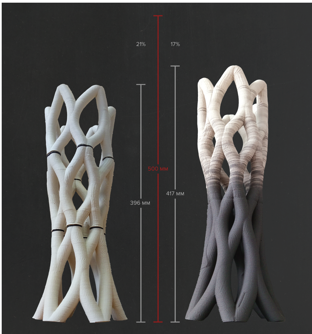
Figura 4.5.a. - Comparação e análise da retração das alturas da coluna impressa em partes (à esquerda) e contínua (à direita), com base na dimensão do desenho digital (traço vermelho).
