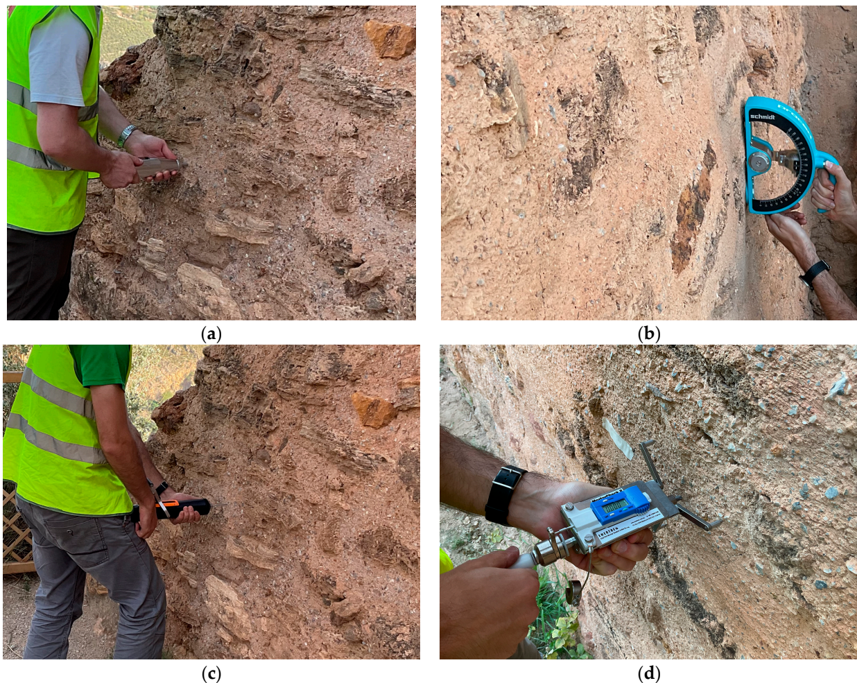
Figure 3. (a) Schmidt hammer; (b) Schmidt pendulum hammer; (c) penetrometer; (d) scratch test instrument.
