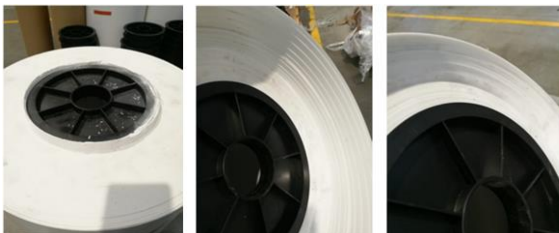
Figura 82 - Desalinhamento das espiras devido a diferenciais de tensão.
