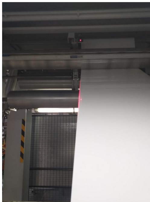
Figura 63 - Alinhamento da folha com o laser de guiamento.
