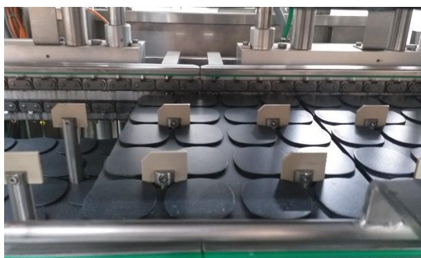
Figura 32 - Aquecedores alveolares utilizados nas máquinas de form-fill-seal .
