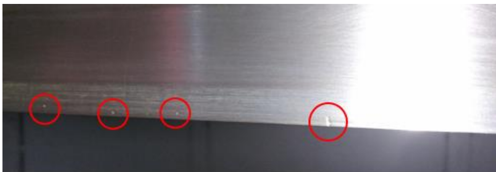
Figura 90 - Fieira danificada responsável pelo risco observado na folha de PET.
