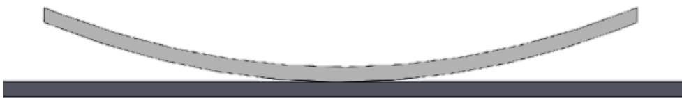
Figura 51 - Representação 3D duma folha com empeno vista de frente.
