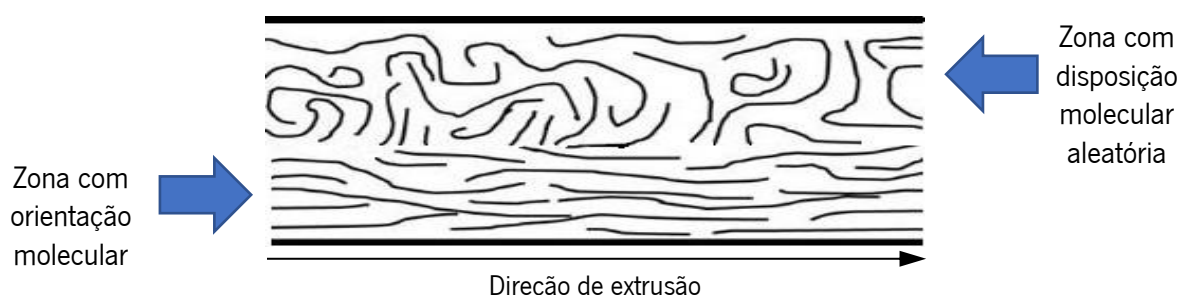
Figura 57 - Representação do gradiente de orientação na direção transversal de extrusão. Adaptada de [137].
