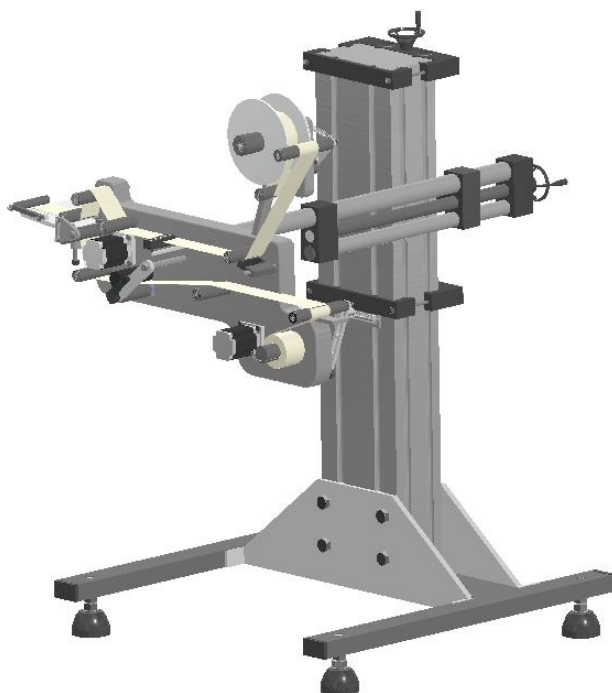
Figura 33 - Máquina de etiquetagem individual projetada.
