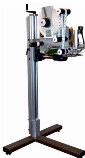
Figura 11 – Máquina de etiquetagem horizontal. Adaptado de [13].
