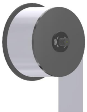
Figura 117 - Modelação de um possível conjunto de desenrolamento.
