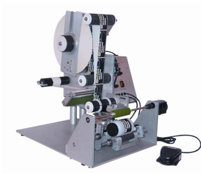
Figura 9 - Máquina de etiquetagem semiautomática de garrafas. Adaptado de [13].
