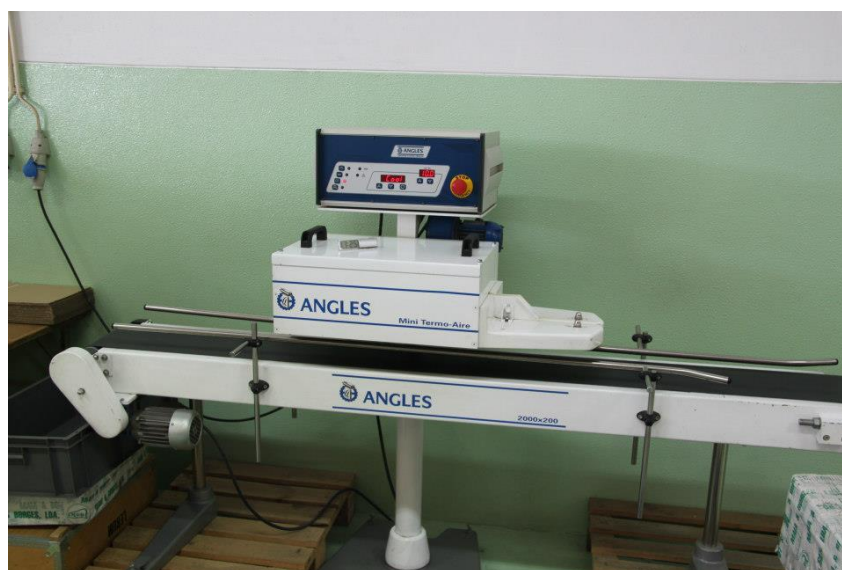
Figura 5 - Máquina na empresa responsável por fechar os sacos de plástico depois do embalamento [1]
