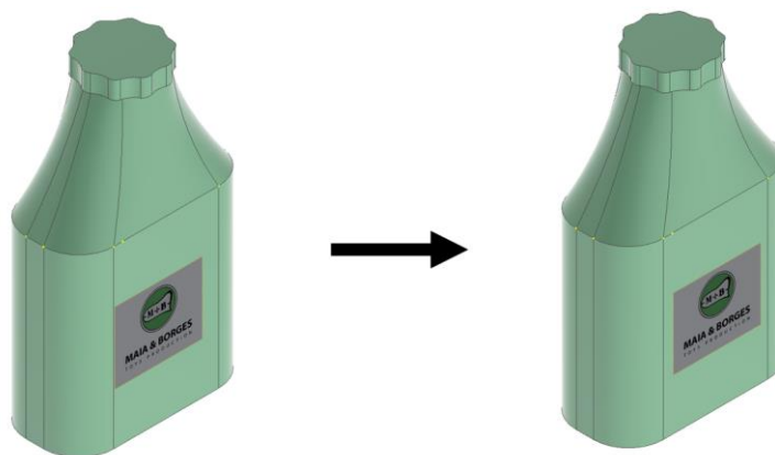
Figura 132 - Influência de um ajuste horizontal na etiquetagem de um produto.
