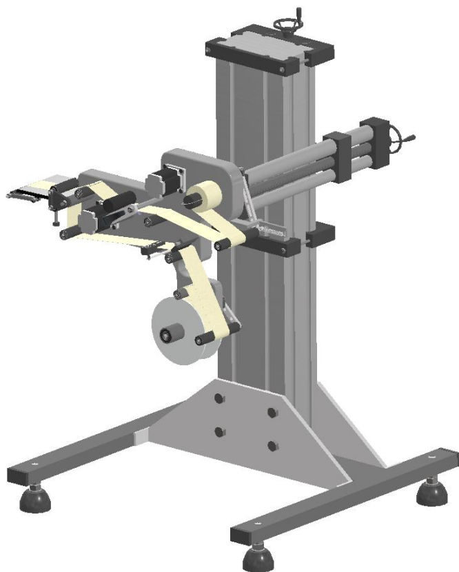
Figura 71 - Modelação final da máquina de etiquetagem de conjunto.
