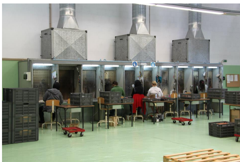
Figura 3 - Pintura geral do brinquedo com o auxílio de uma pistola convencional [1].
