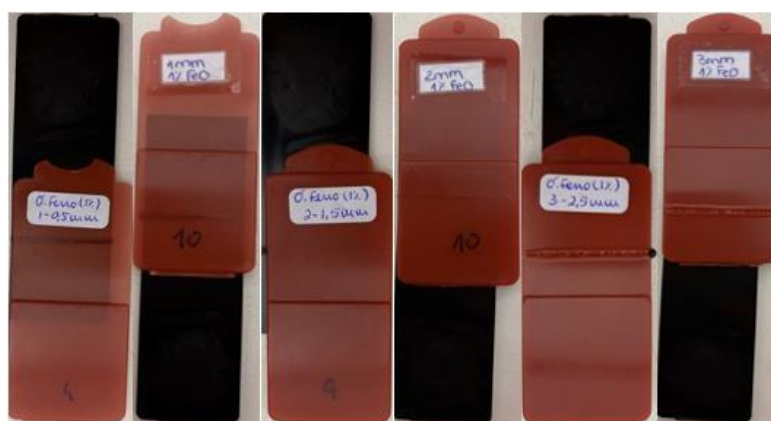
Figura 69 - Soldadura a Laser por Transmissão (SLT), do Óxido de Ferro com concentração de 1%.
