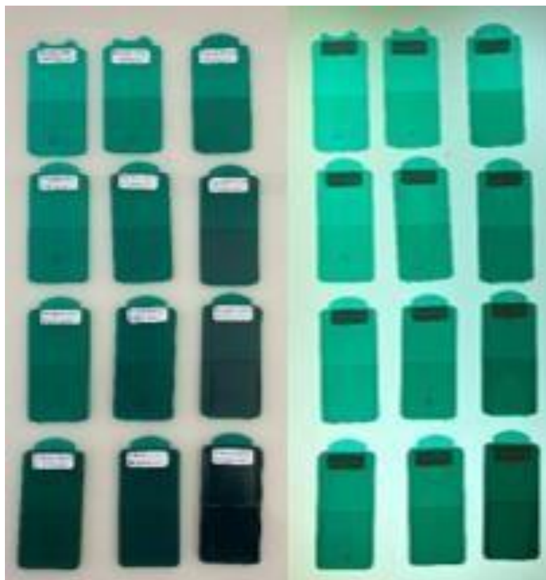
Figura 165 - Provetes em PMMA com 0.5%,1% e 2% de Pigmento Verde 7, (à direita com luz).
