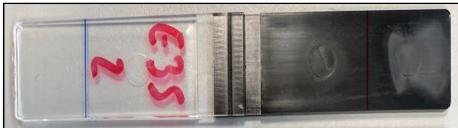
Figura 31 - Peça soldada (Segundo caso de estudo PC/ABS com rib triangular)
