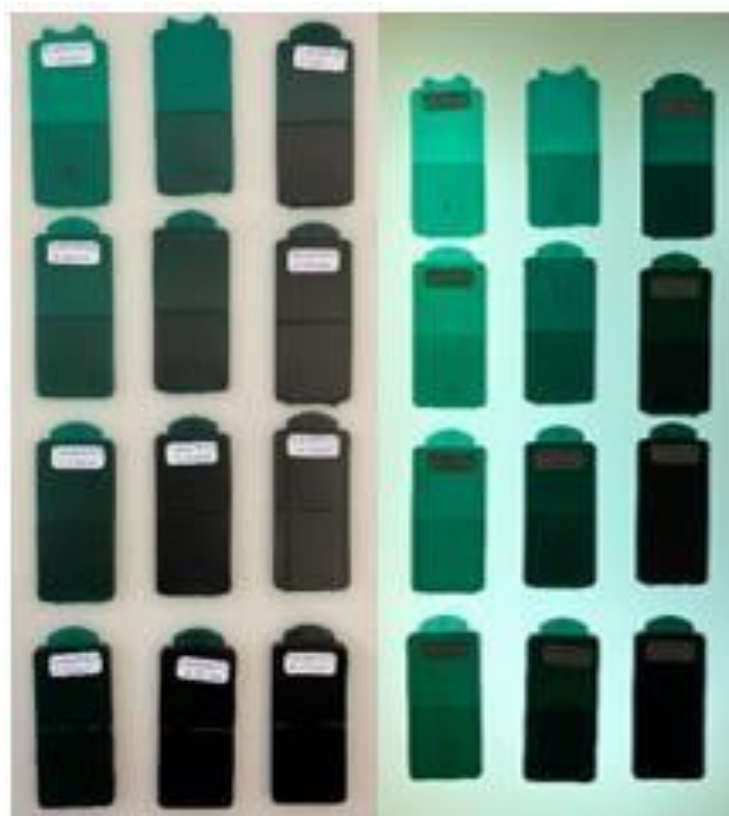
Figura 171 - Provetes em PMMA com 0.5%,1% e 2% de Solvente Verde 28, (à direita com luz).
