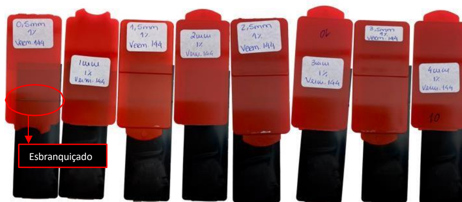
Figura 56 - Soldadura a Laser por Transmissão (SLT), do Vermelho 144 com concentração de 1%.
