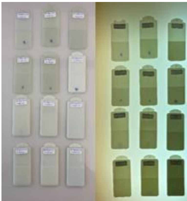
Figura 173 - Provetes em PMMA com 0.5%,1% e 2% de Pigmento Inorgânico Dióxido de Titânio, (à direita com luz).
