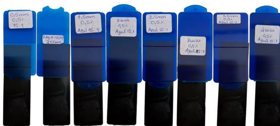
Figura 61 - Soldadura a Laser por Transmissão (SLT), do Azul 15:1 com concentração de 0,5%.
