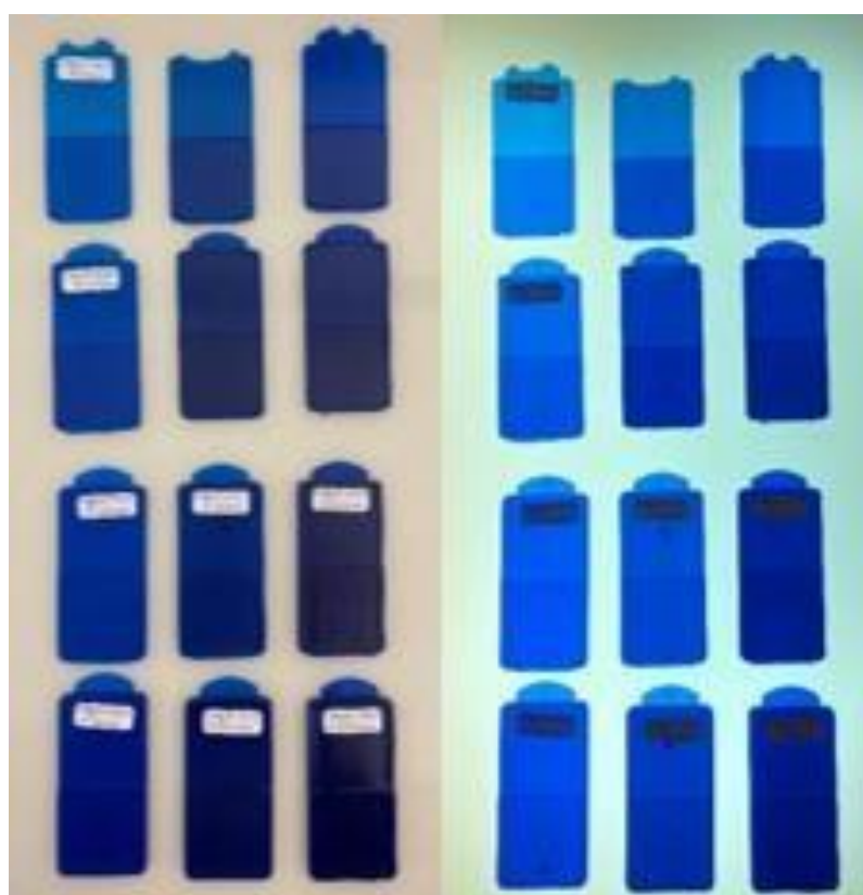
Figura 164 - Provetes em PMMA com 0.5%,1% e 2% de Pigmento Azul 15:1, (à direita com luz).
