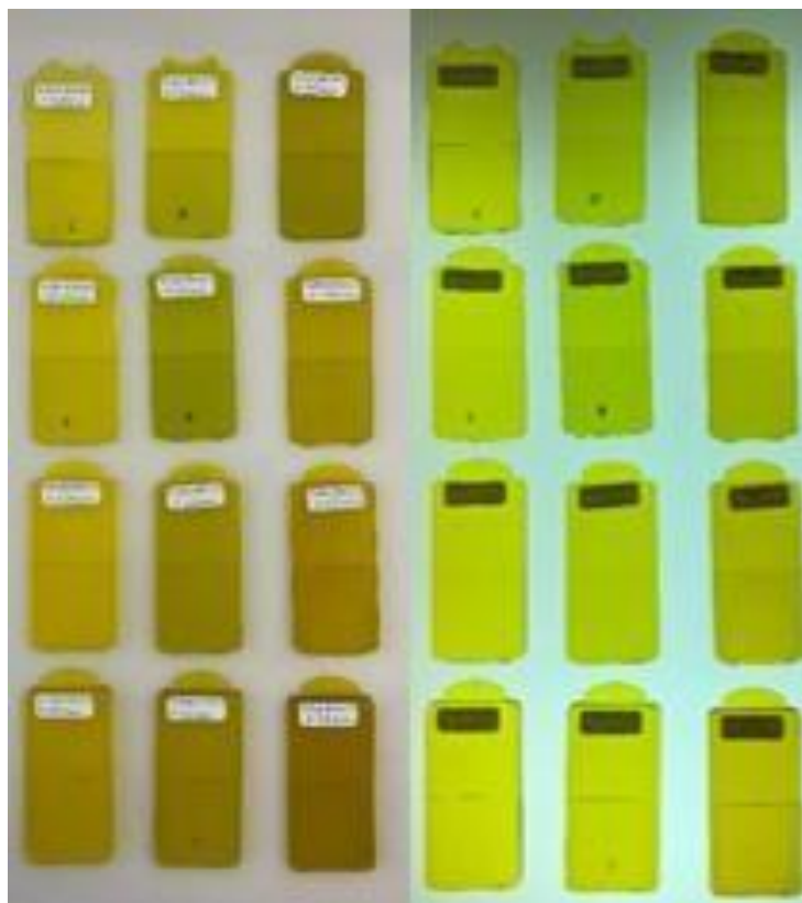
Figura 169 - Provetes em PMMA com 0.5%,1% e 2% de Solvente Amarelo 114, (à direita com luz).
