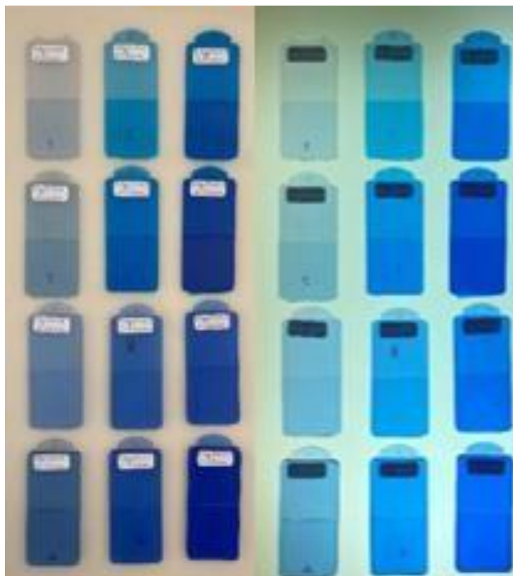
Figura 167 - Provetes em PMMA com 0.5%,1% e 2% de Pigmento Azul 29, (à direita com luz).
