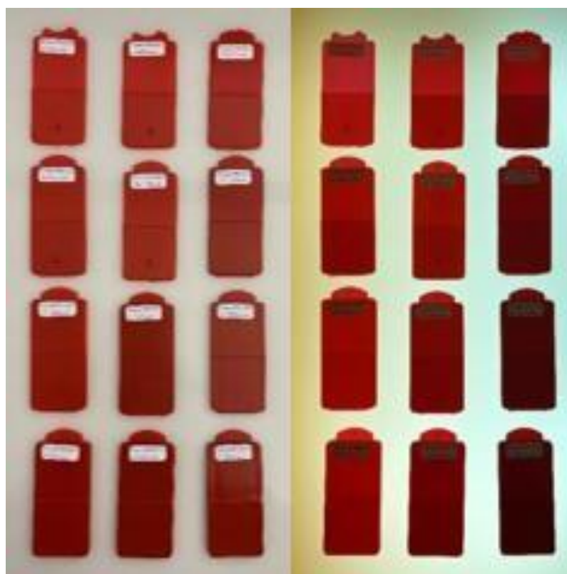
Figura 163 - Provetes em PMMA com 0.5%,1% e 2% de Pigmento Vermelho 144, (à direita com luz).
