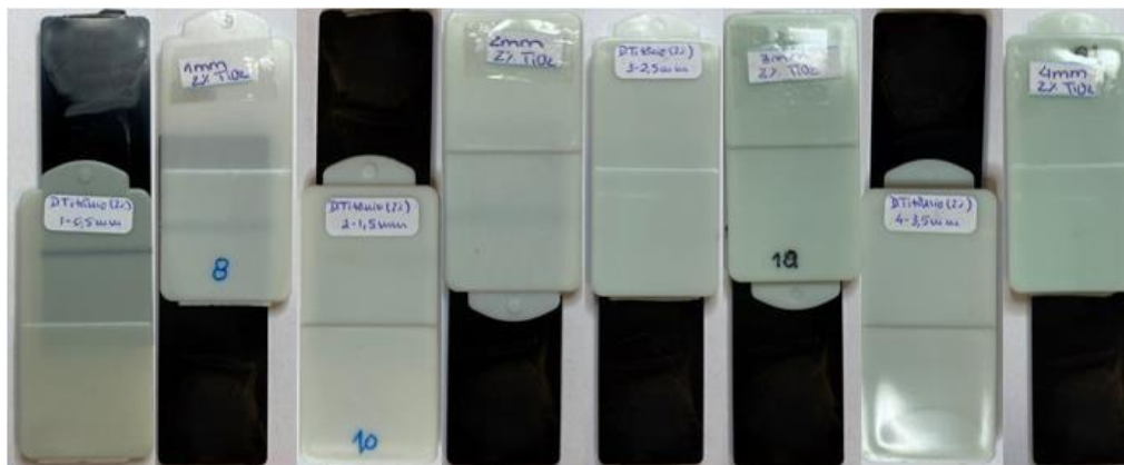
Figura 67 - Soldadura a Laser por Transmissão (SLT), do Dióxido de Titânio com concentração de 2%.
