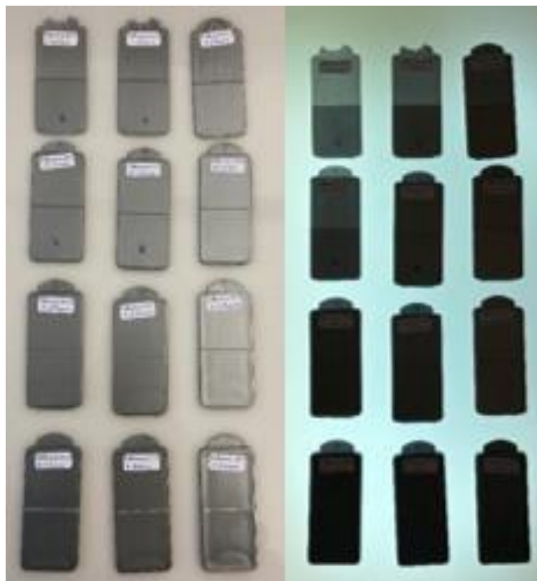
Figura 175 - Provetes em PMMA com 0.5%,1% e 2% de Pigmento Metálico Alumínio, (à direita com luz).
