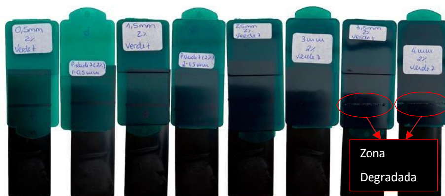
Figura 54 - Soldadura a Laser por Transmissão (SLT), do Verde 7 com concentração de 2%.
