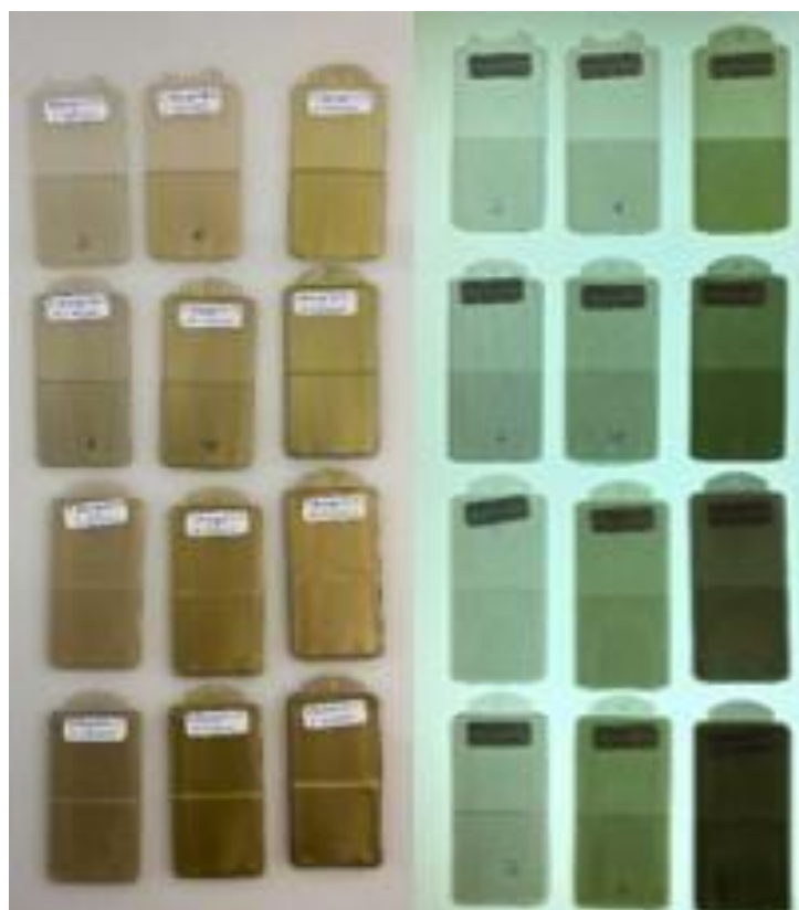
Figura 176 - Provetes em PMMA com 0.5%,1% e 2% de Pigmento Metálico Bronze, (à direita com luz).
