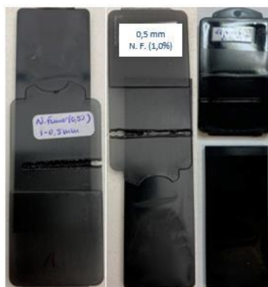
Figura 64 - Soldadura a Laser por Transmissão (SLT), do Negro de Fumo com concentração de 0,5%, 1% e 2%.
