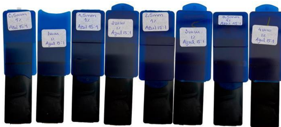
Figura 62 - Soldadura a Laser por Transmissão (SLT), do Azul 15:1 com concentração de 1%.
