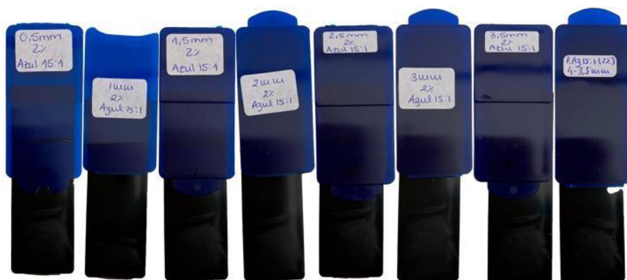
Figura 63 - Soldadura a Laser por Transmissão (SLT), do Azul 15:1 com concentração de 2%.
