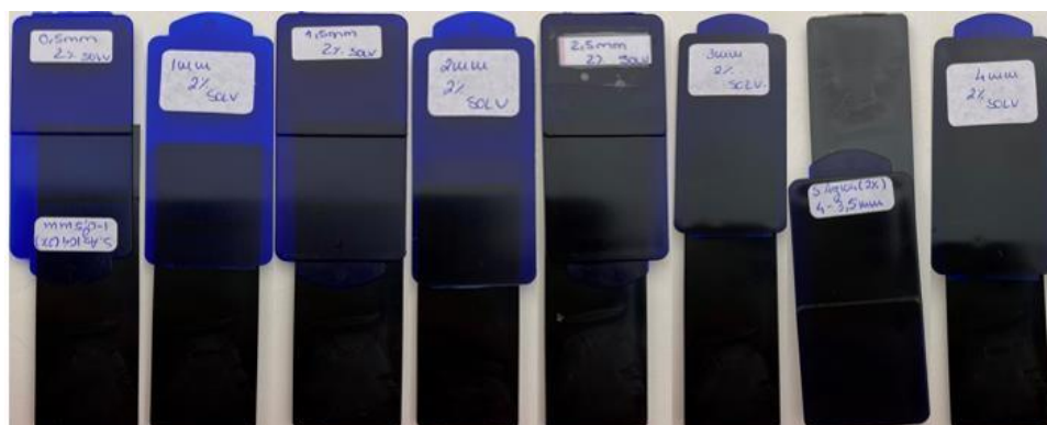
Figura 89 - Soldadura a Laser por Transmissão (SLT), do Azul 104 com concentração de 2%.
