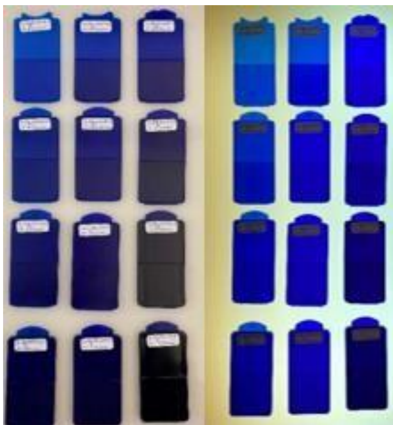
Figura 170 - Provetes em PMMA com 0.5%,1% e 2% de Solvente Azul 104, (à direita com luz).
