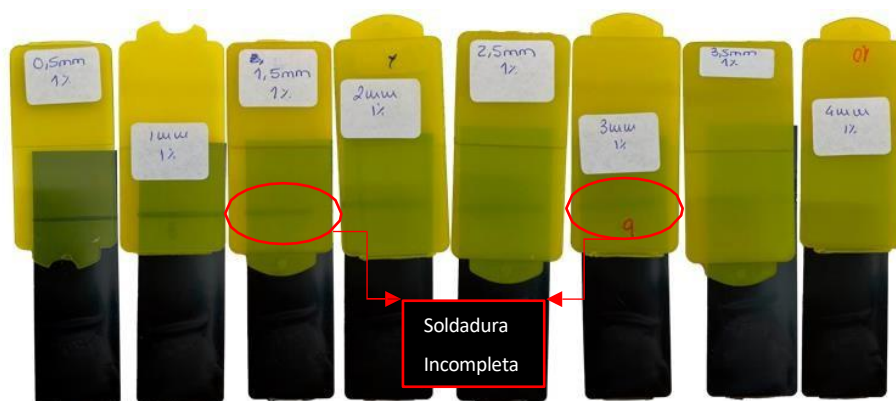
Figura 59 - Soldadura a Laser por Transmissão (SLT), do Amarelo 191 com concentração de 1%.
