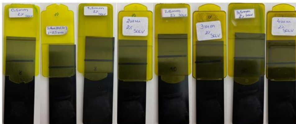
Figura 86 - Soldadura a Laser por Transmissão (SLT), do Amarelo 114 com concentração de 2%.
