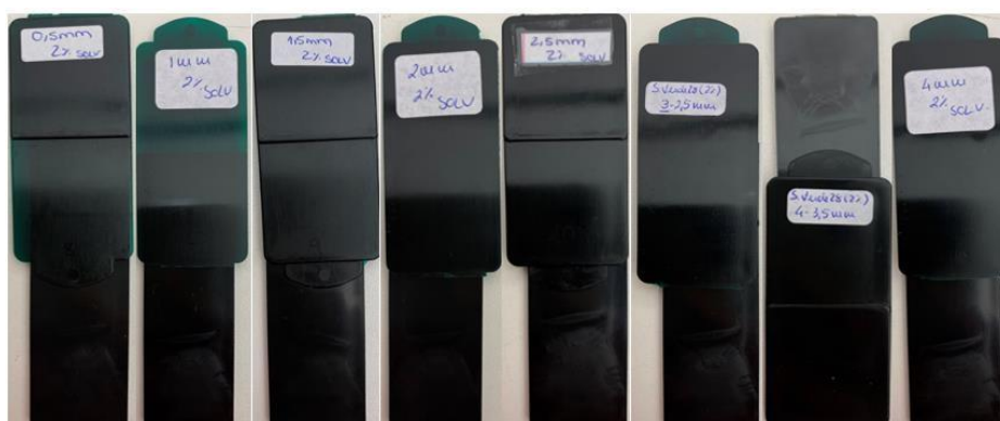
Figura 80 - Soldadura a Laser por Transmissão (SLT), do Verde 28 com concentração de 2%.
