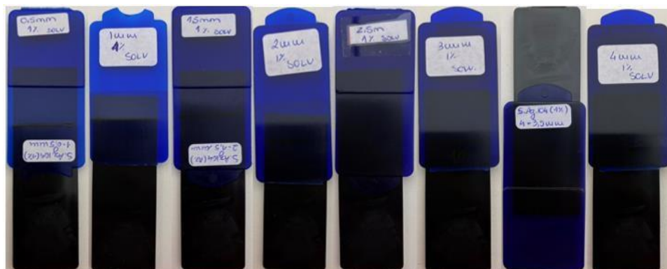
Figura 88 - Soldadura a Laser por Transmissão (SLT), do Azul 104 com concentração de 1%.
