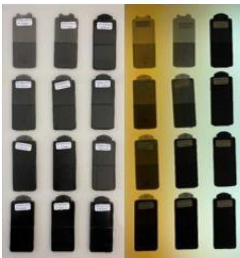
Figura 174 - Provetes em PMMA com 0.5%,1% e 2% de Pigmento Inorgânico Negro de Fumo, (à direita com luz).
