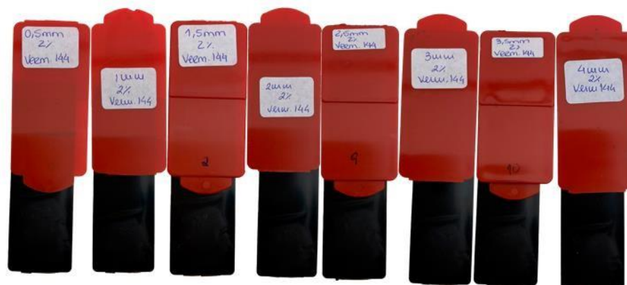
Figura 57 - Soldadura a Laser por Transmissão (SLT), do Vermelho 144 com concentração de 2%.
