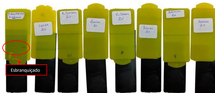
Figura 60 - Soldadura a Laser por Transmissão (SLT), do Amarelo 191 com concentração de 2%.
