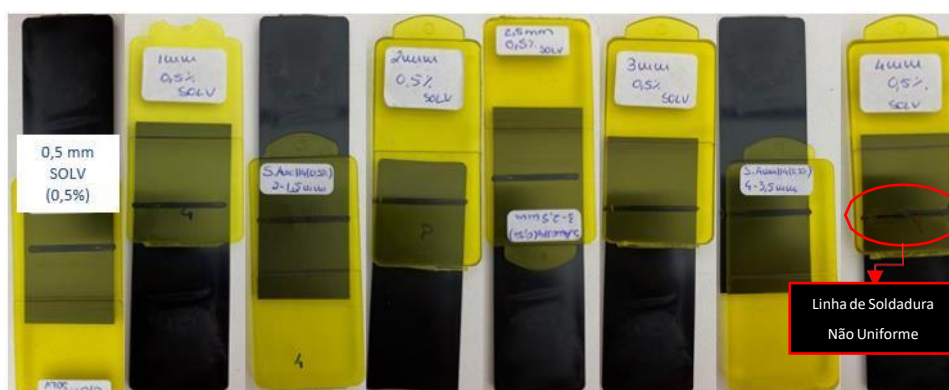
Figura 84 - Soldadura a Laser por Transmissão (SLT), do Amarelo 114 com concentração de 0,5%.
