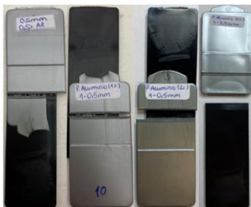
Figura 74 - Soldadura a Laser por Transmissão (SLT), do Alumínio com concentração de 0,5%, 1% e 2%.
