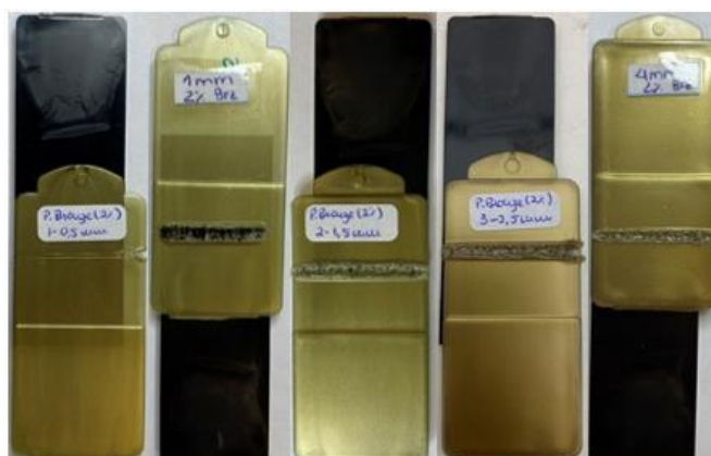
Figura 77 - Soldadura a Laser por Transmissão (SLT), do Bronze com concentração de 2%.
