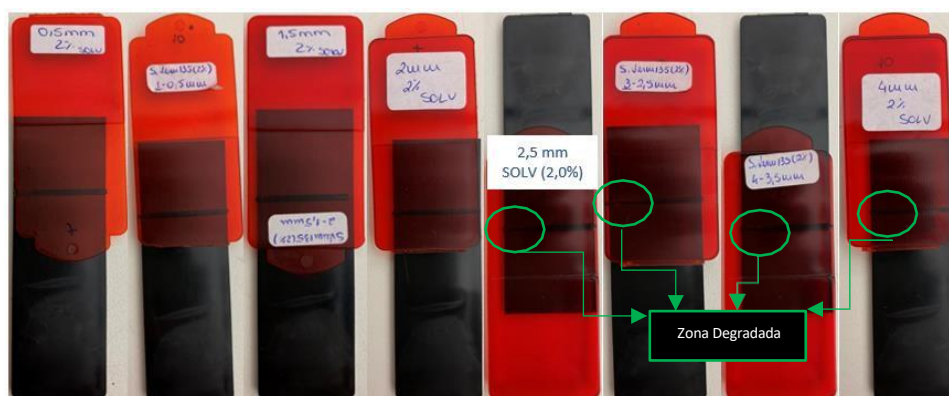
Figura 83 - Soldadura a Laser por Transmissão (SLT), do Vermelho 135 com concentração de 2%.
