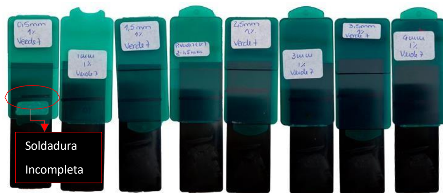
Figura 53 - Soldadura a Laser por Transmissão (SLT), do Verde 7 com concentração de 1%.
