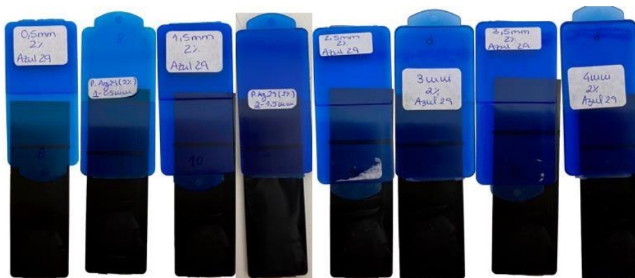
Figura 73 - Soldadura a Laser por Transmissão (SLT), do Azul 29 com concentração de 2%.
