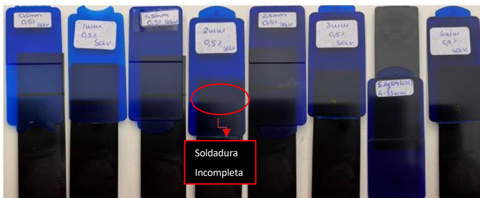
Figura 87 - Soldadura a Laser por Transmissão (SLT), do Azul 104 com concentração de 0,5%.
