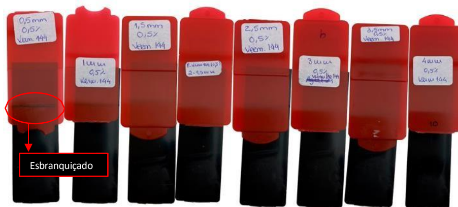
Figura 55 - Soldadura a Laser por Transmissão (SLT), do Vermelho 144 com concentração de 0,5%.
