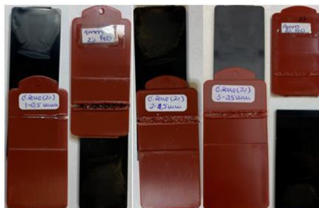
Figura 70 - Soldadura a Laser por Transmissão (SLT), do Óxido de Ferro com concentração de 2%.
