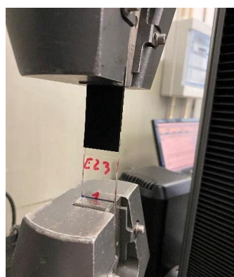
Figura 32 - Provede fixo com 90 mm de distância entre amarras
