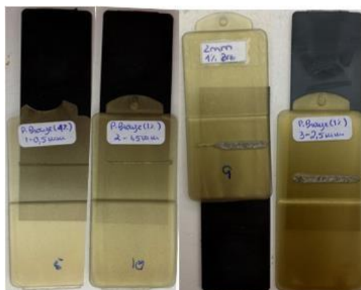
Figura 76 - Soldadura a Laser por Transmissão (SLT), do Bronze com concentração de 1%.
