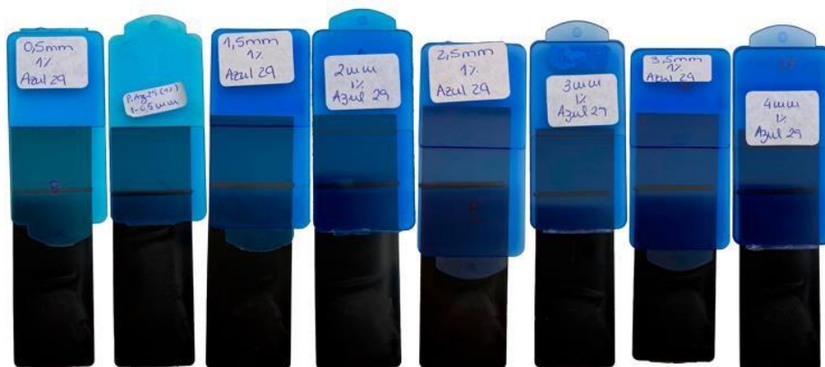
Figura 72 - Soldadura a Laser por Transmissão (SLT), do Azul 29 com concentração de 1%.
