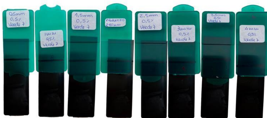
Figura 52 - Soldadura a Laser por Transmissão (SLT), do Verde 7 com concentração de 0,5%
