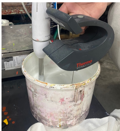
Figura 4: Medição da viscosidade com um viscosímetro (Fonte: Foto Própria)
