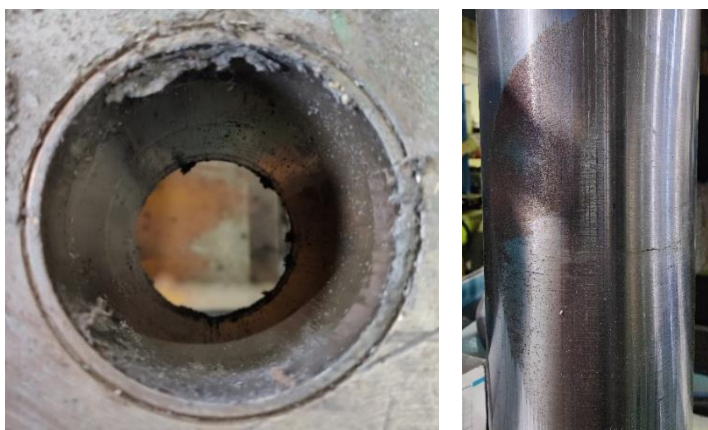
Figura 8.13 – Acumulação de resíduos e desgaste nas hastes, respectivamente.
