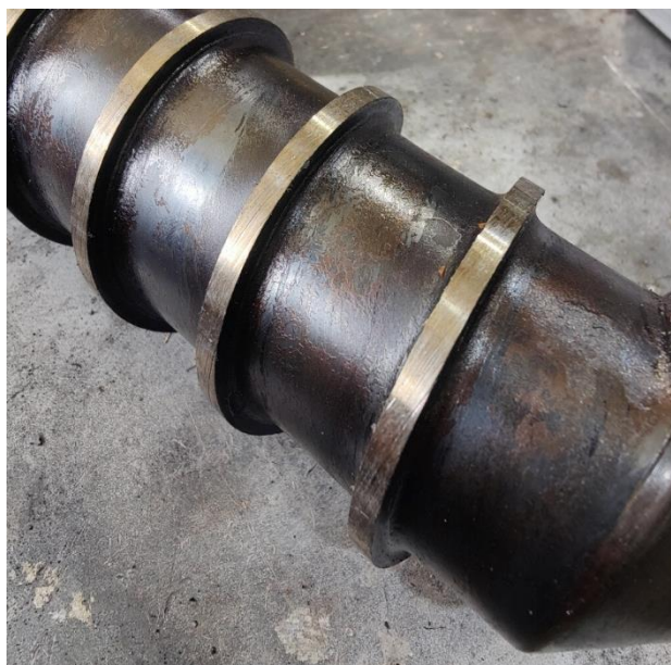
Figura 8.1 – Desgaste no fuso.
