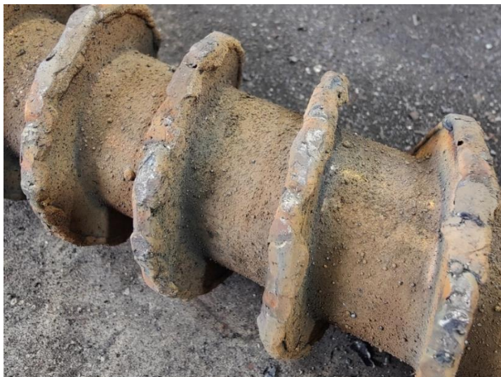
Figura 8.3 – Soldadura dos filetes para recuperação da folga desejada.
