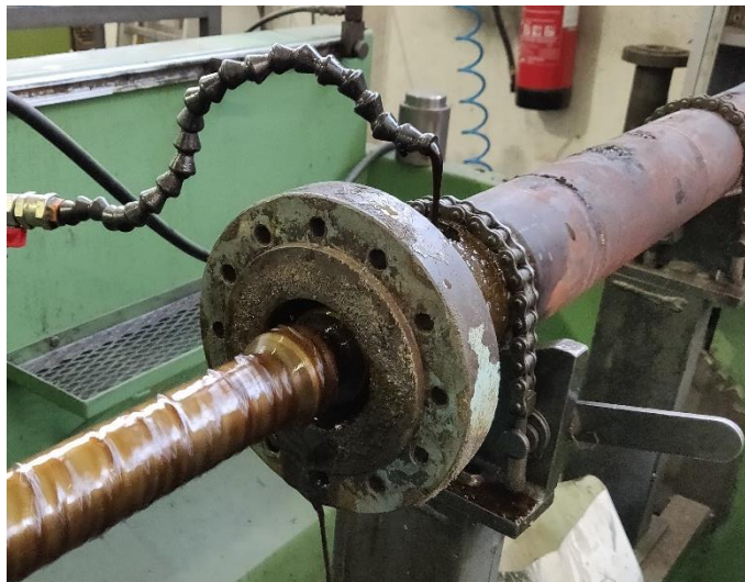
Figura 8.2 – Processo de retificação da camisa.
