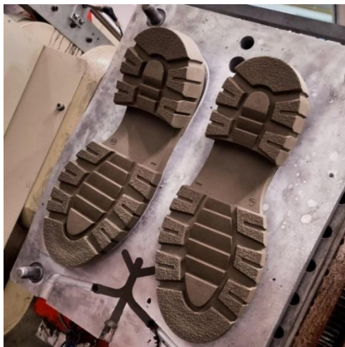
Figura 3.4 – Exemplo de uma sola produzida numa máquina de extrusão [14].
