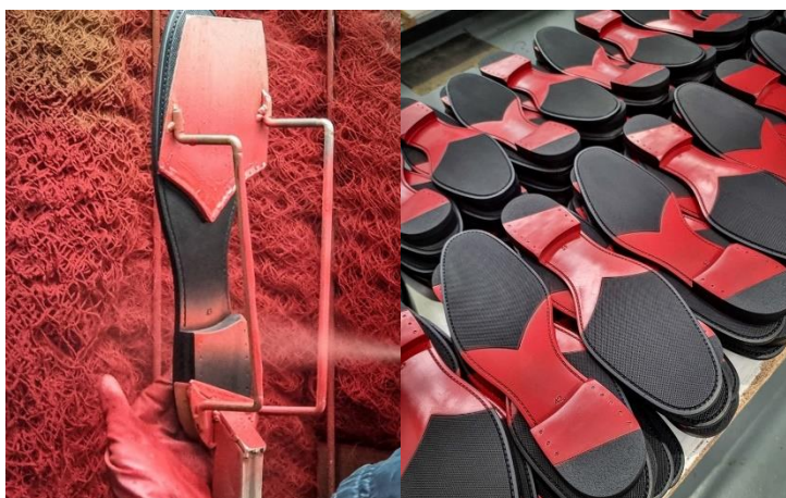
Figura 3.5 – Pintura de uma sola e produto final [14].
