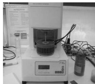
Figura 96 Reómetro de pratos paralelos utilizado.
