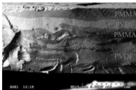
Figura 12 Exemplo de um filme planar com camadas intermisturadas [30].
