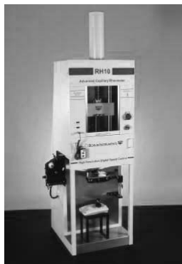
Figura 94 Reómetro capilar utilizado.
