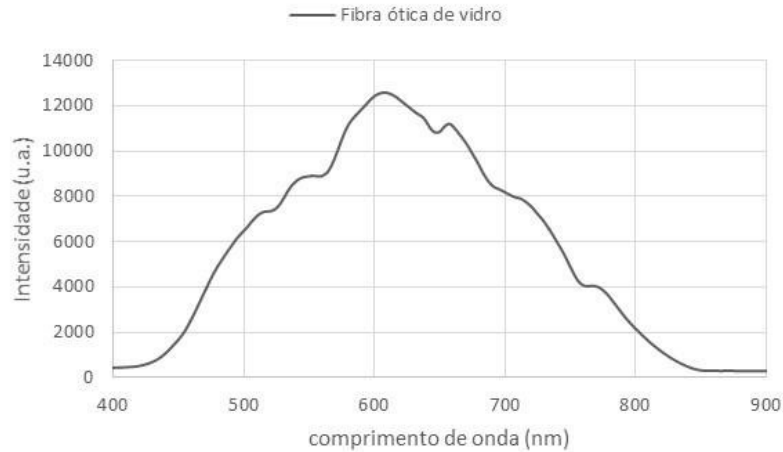
Figura 41 Caracterização de uma fibra ótica de vidro existente no Departamento de Física.
