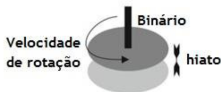
Figura 20 Diagrama esquemático do funcionamento do reómetro de pratos paralelos, para realização de ensaios em corte.
