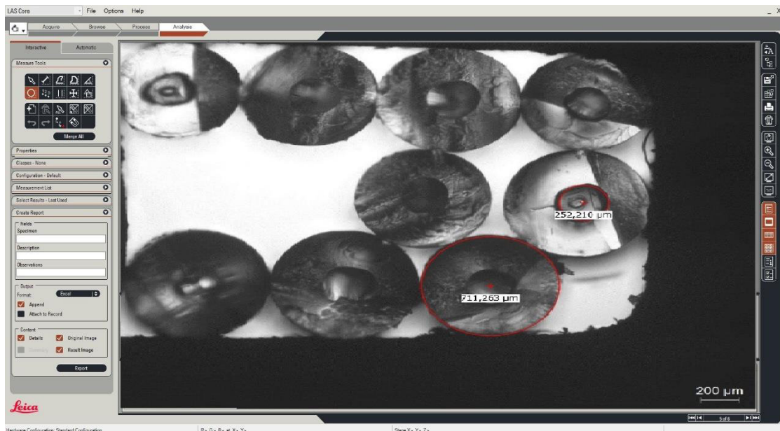
Figura 37 Interface entre o software e a câmara digital, representativa da medição do diâmetro das camadas constituintes das POF.
