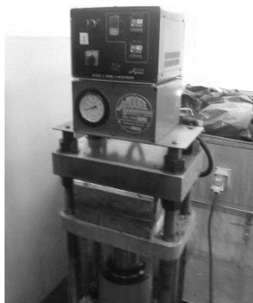
Figura 95 Prensa utilizada na preparação de amostras.
