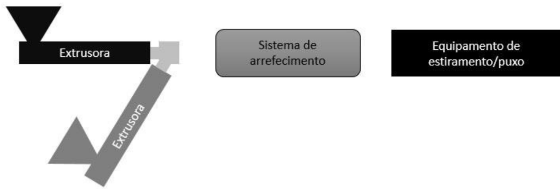
Figura 24 Esquema completo de uma linha típica de coextrusão.
