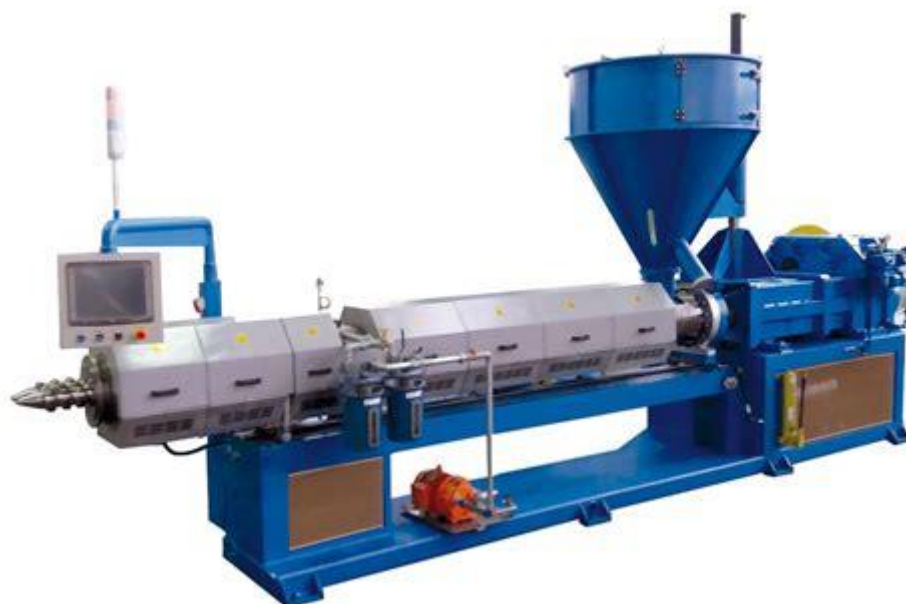
Figura 2.3.2 - Exemplo de uma extrusora utilizada na indústria de produção de pneus.
