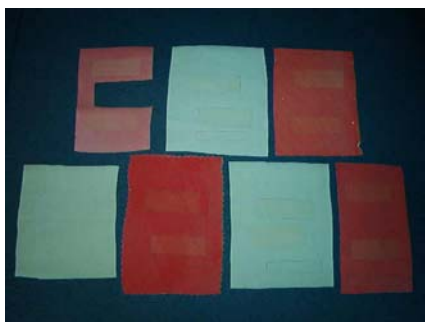
Fig.35: amostras após teste de solidez de 20h
