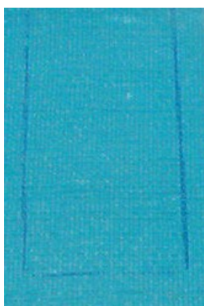
Fig. 72: 100% Fotocromáticos em exposição aos UVs, após 24h de desgaste em meio ambiente.
