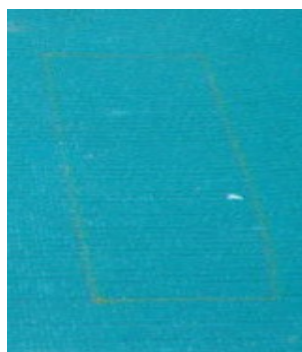
Fig. 46: 100% Fotocromáticos em situação de sombra, após 5h de desgaste na QUV.
