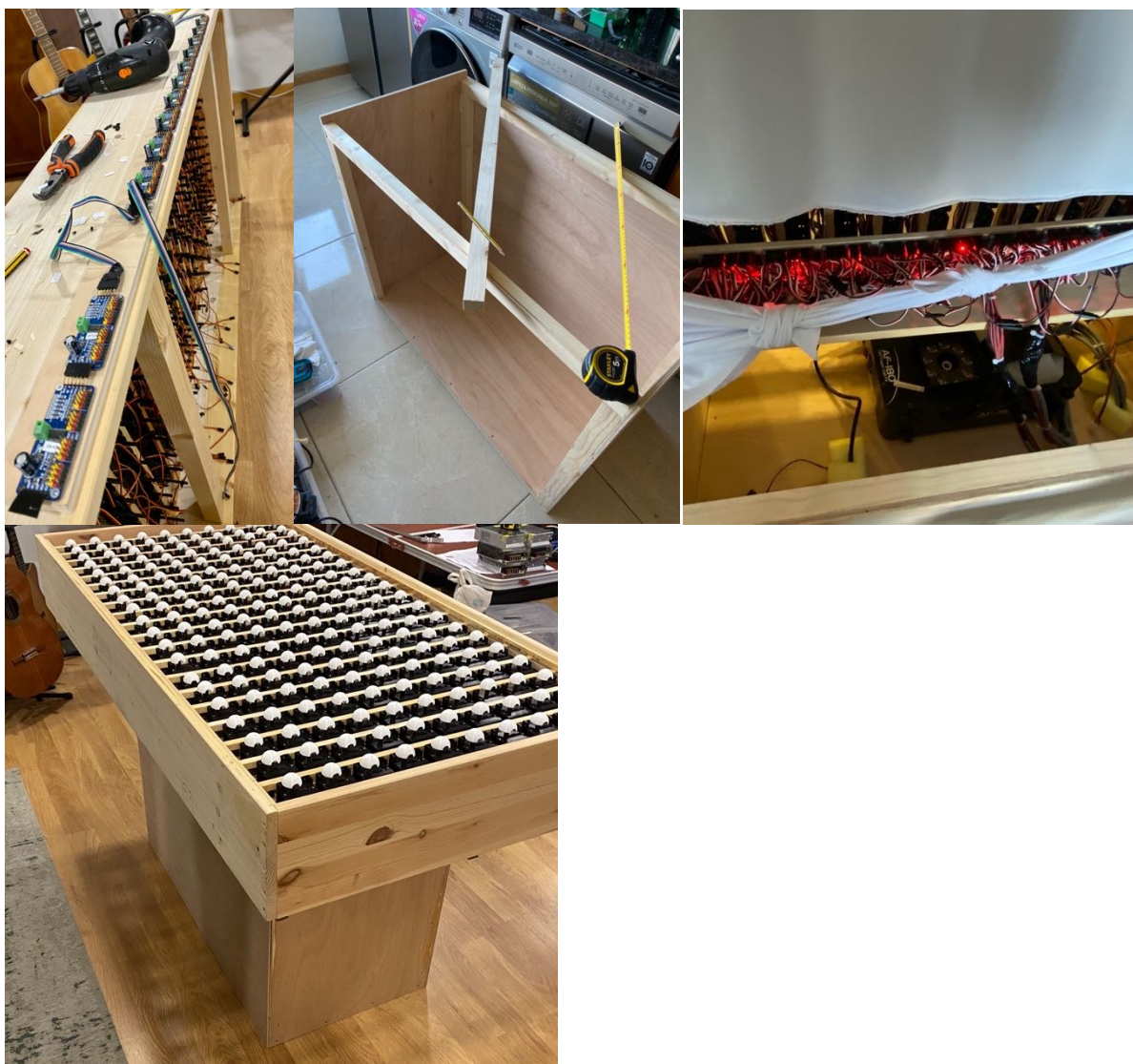
Figura 16: Sequência da montagem da estrutura
