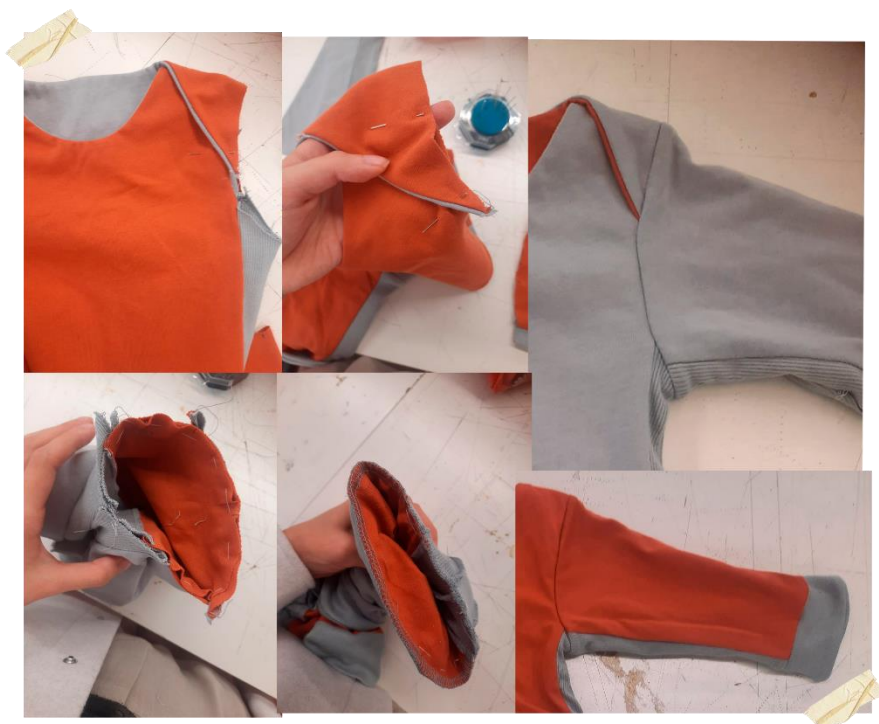
Figura 51 – União da manga à base da camisola
