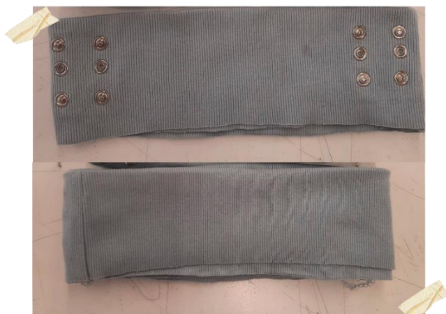
Figura 54 – Construção do có do tapa-fraldas
