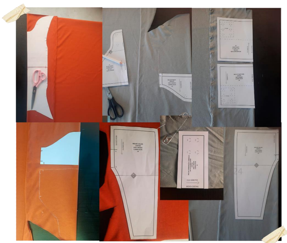
Figura 48 – Marcação e corte dos moldes nos materiais têxteis
