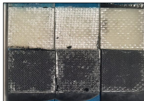
Figura 41 - Superfícies da juntas (Econostitch)
