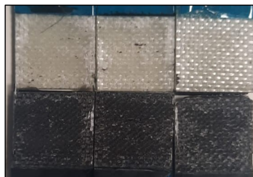
Figura 43 - Superfícies da junta (Twill)
