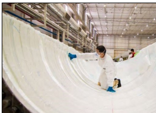
Figura 4 - Lay-Up materiais (adaptado de Thays Marinho, 2021)
