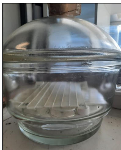
Figura 18 - Provetes durante o ensaio de absorção de humidade
