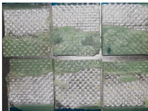
Figura 45 - Superfícies das juntas (Twil_L1- 35°C)
