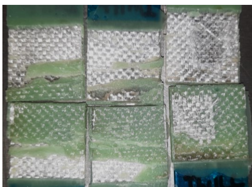
Figura 46 - Superfícies das juntas (Twil_L2- 23°C)
