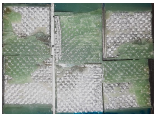
Figura 44 - Superfícies das juntas (Twil_L1- 23°C)
