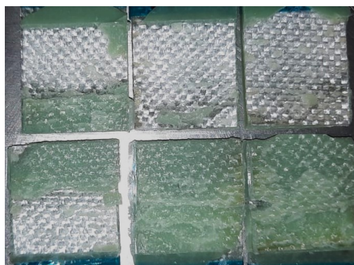
Figura 47 - Superfícies das juntas (Twil_L2- 35°C)
