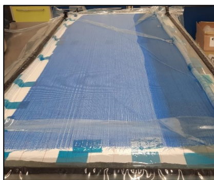
Figura 10 - Produção do laminado L2
