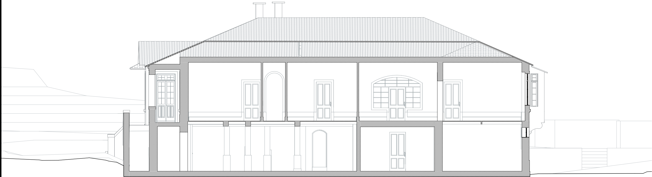
PERFIL LONGITUDINAL EE' | EXISTENTE
