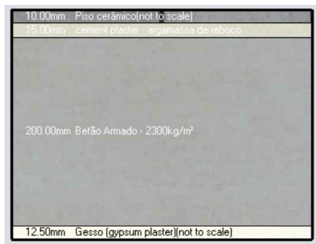
Figura 26 – Constituição da laje entre pisos do edifício.
