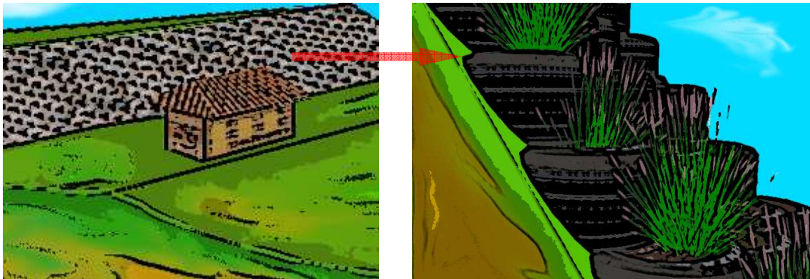
Fig.3 Alternativa de contenção de encostas com pneus
