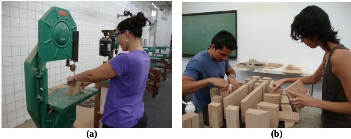
Fig. 4 Etapas de construção da maquete: corte da placa de MDF na oficina da FAU/UFRJ (a) e montagem da maquete usada nos testes (b).
