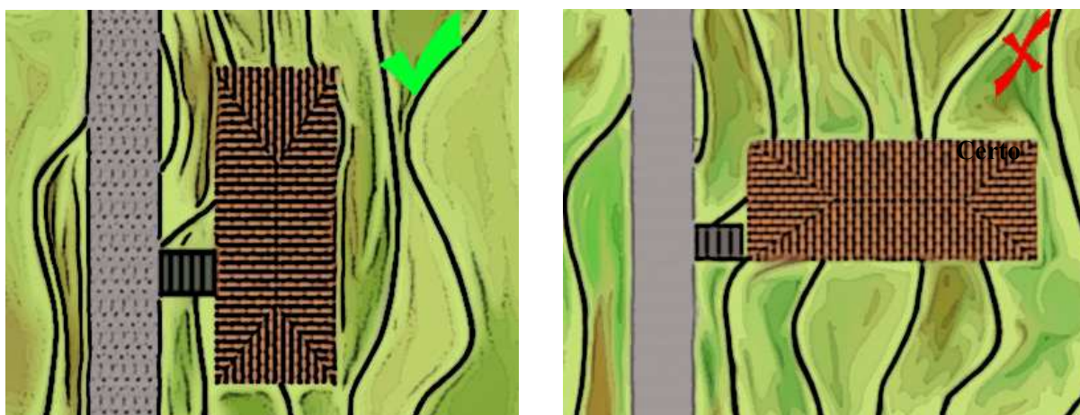
Fig.1 Croquis Esquemáticos exemplificando uma implantação correta e outra incorreta em encosta.
