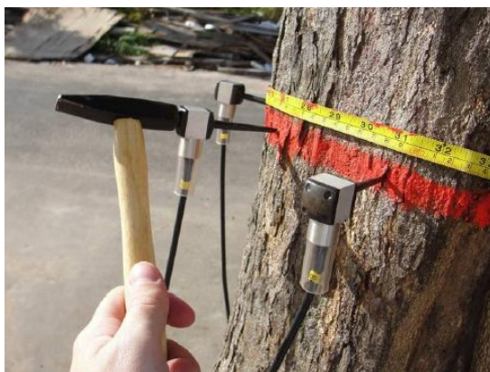
Fig. 2 Aplicação de impulsos nos sensores para emissão das ondas
