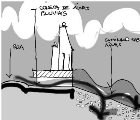
Fig.6 Coleta de Águas Pluviais
