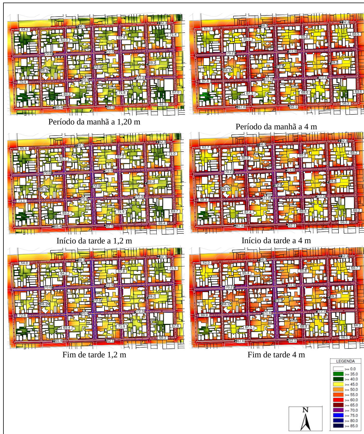
Fig.5 Mapas de ruído para a situação atual no recorte urbano nos períodos da manhã, início da tarde e fim da tarde à altura de 1,2 metros e de 4 metros acima do solo
