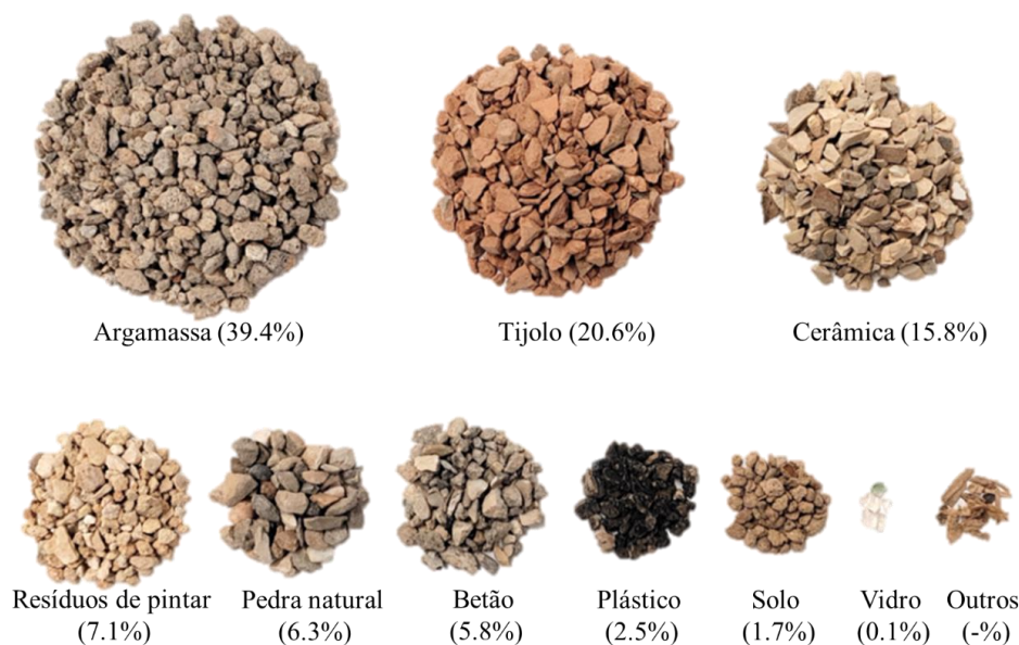
Figura 5.4 – A proporção de cada material na massa total de AR.
