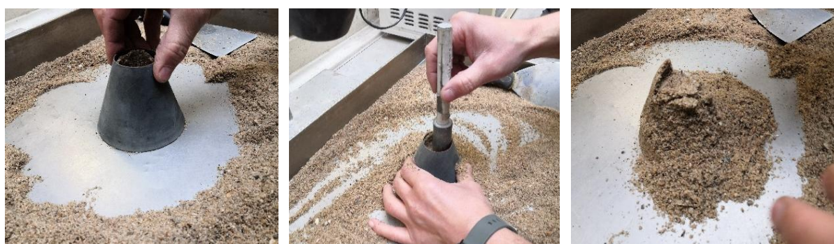
(a) Colocação do cone no tabuleiro
