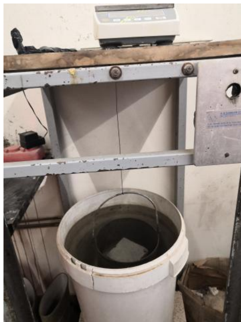
Figura 4.5 - Pesagem do provete saturado imerso em água.
