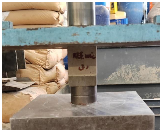
Figura 4.7 - Ensaio de resistência à compressão.
