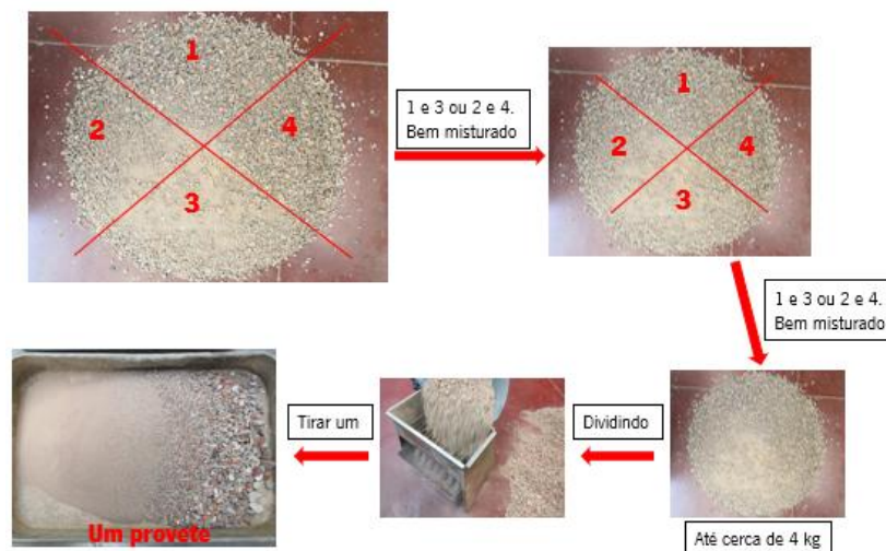
Figura 4.3 – Processo de preparação da amostra para o ensaio de granulometria.
