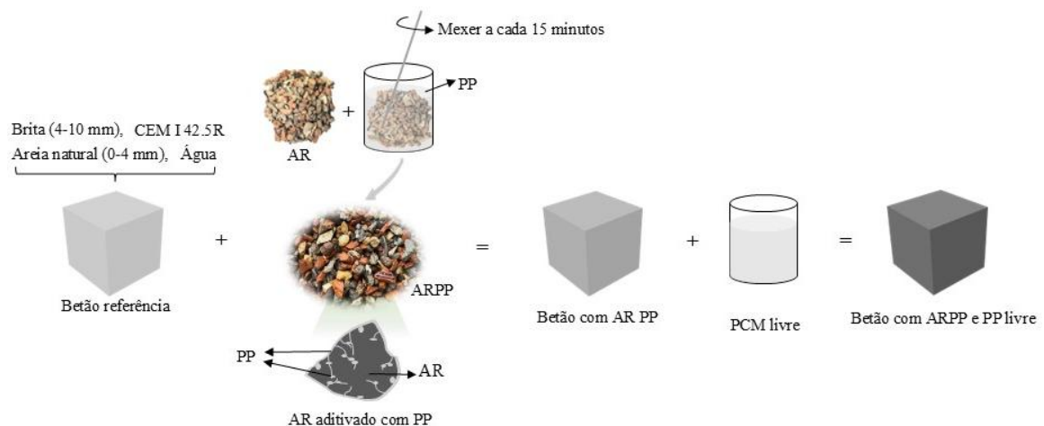
Figura 5.13 – O processo de preparação de terceiras composições.
