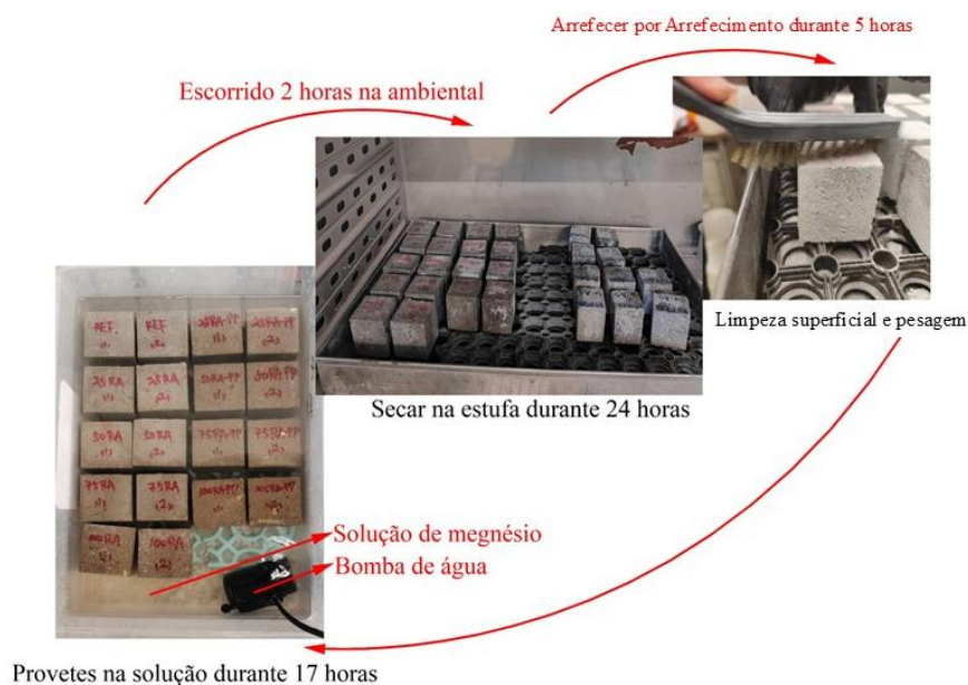
Figura 4.12 - Diagrama esquemático do ensaio de resistência do betão ao sulfato de magnésio.
