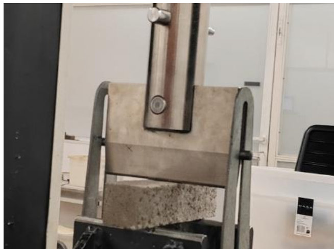
Figura 4.8 - Ensaio à flexão de um provete de betão.
