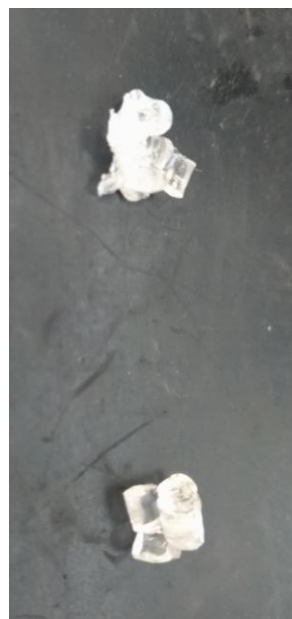
Figura 37 – Aglomerados de material resultantes da elevada temperatura da tremonha.
