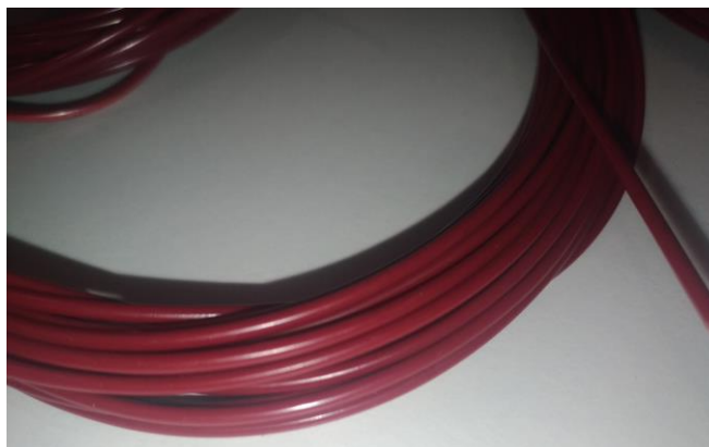
Figura 45 – Aparência superficial do filamento de ABS processado a 170 °C.
