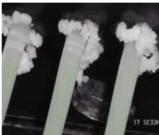
Figura 11 – Fenómeno de die drool . [34]
