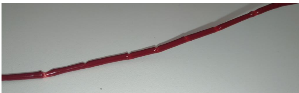
Figura 42 – Aspeto do filamento extrudido com fieira de 3 mm.
