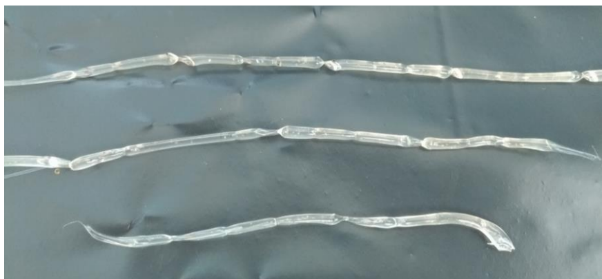
Figura 43 – Aspeto de filamentos extrudidos com fieira de 3 mm.
