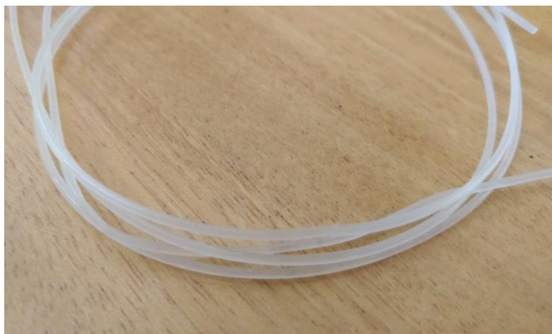
Figura 55 – Aspeto superficial dos filamentos de PLA processados a 170 °C.
