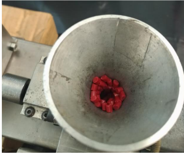
Figura 74 – Grânulos de material “agarrados” às paredes da tremonha devido ao sobreaquecimento da mesma.
