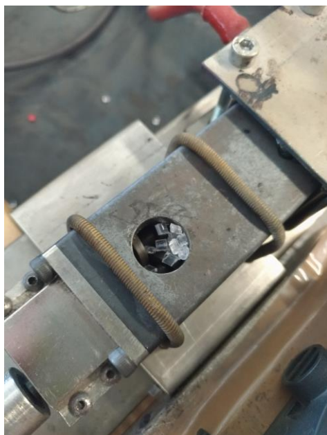
Figura 36 – Grânulos colados na parede da extrusora impedindo a passagem para os parafusos.
