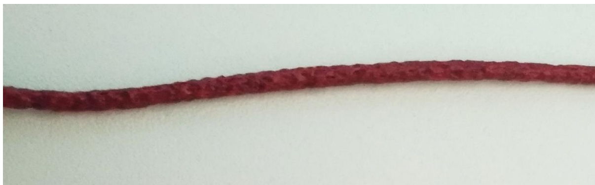
Figura 20 - Aspeto superficial do filamento de ABS processado à temperatura de 230 °C.
