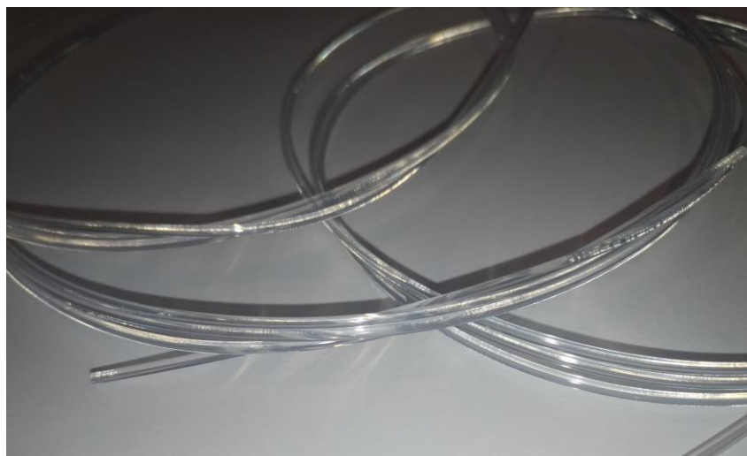
Figura 64 – Aparência superficial dos filamentos de PS processados a 180 °C.
