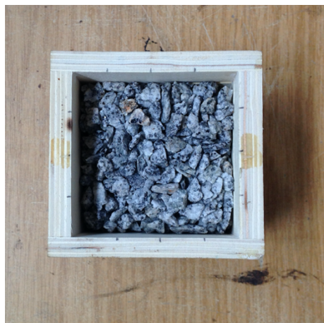
Figura 5.57 - Agregado 4/6 na caixa de dimensões 5x5x6cm 3
