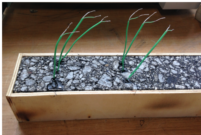
Figura 5.8 - Provete de mistura betuminosa com agregado inferior a 16 mm
