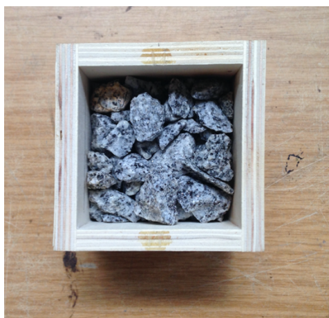
Figura 5.63 - Agregado 6/14 na caixa de dimensões 5x5x6cm 3
