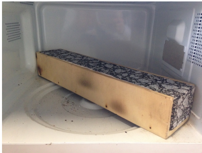
Figura 4.12 - Exemplo do posicionamento dos provetes no interior do micro-ondas
