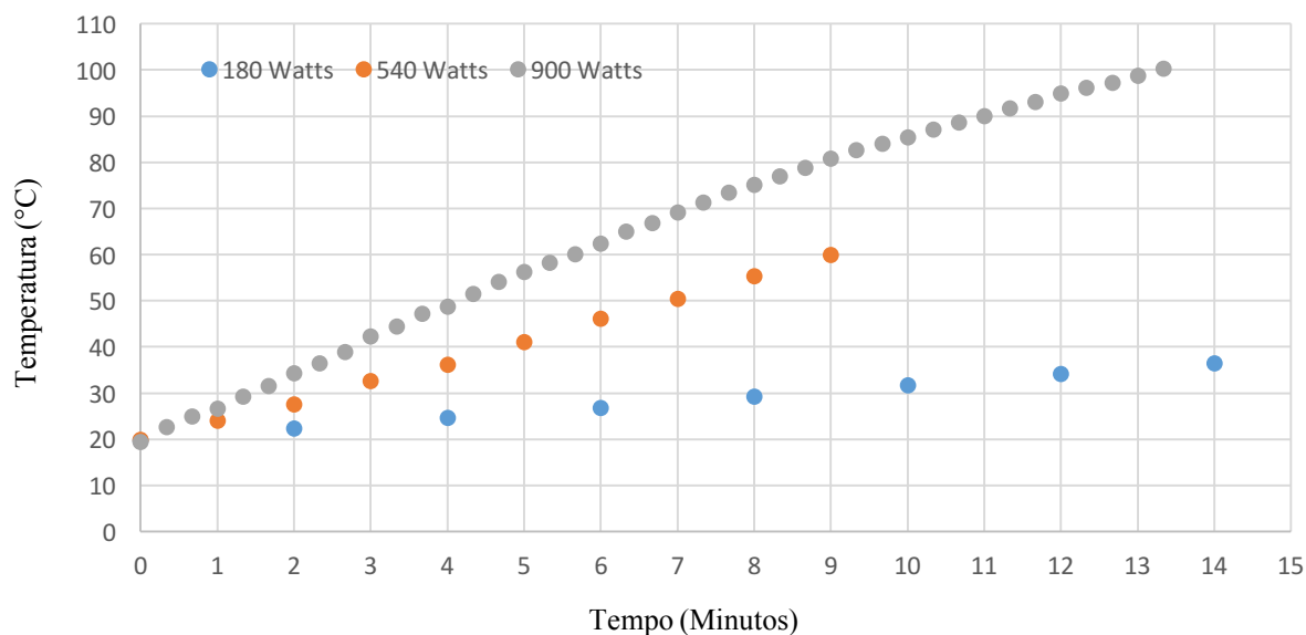
Figura 5.47 - Influência da potência do micro-ondas no aquecimento do provete de calcário
