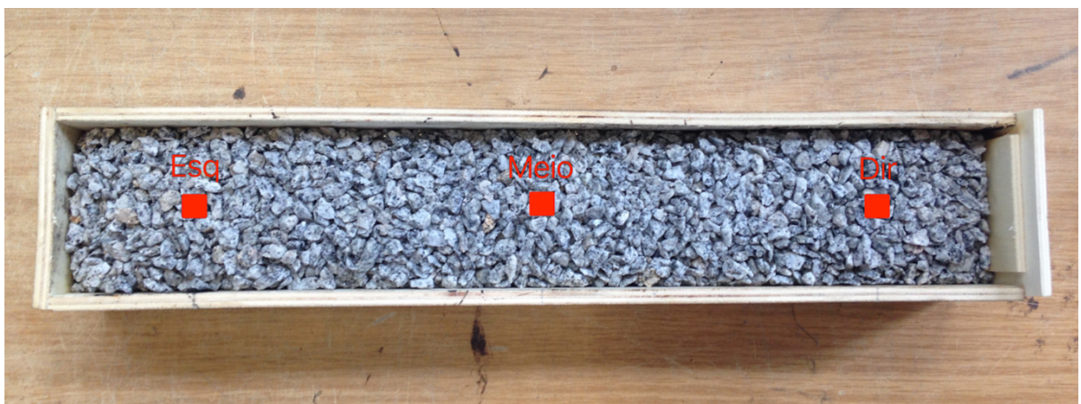
Figura 5.56 - Agregado 4/6 na caixa de dimensões 38 \times 5 \times 6 \text{ cm}^3
