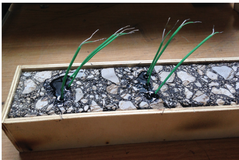
Figura 5.41 - Provete de calcário
