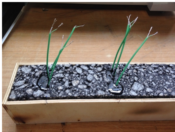
Figura 5.35 – Provete de mistura betuminosa com 17% de vazios
