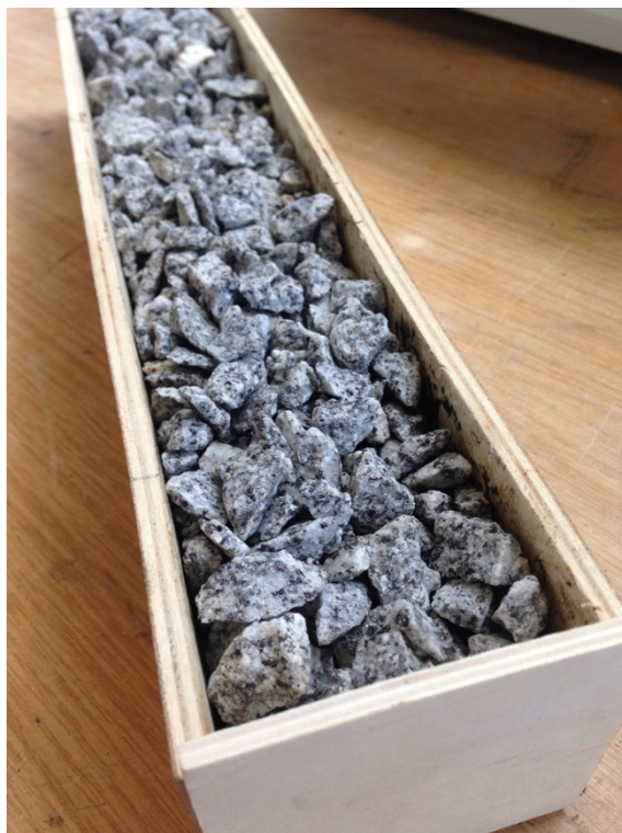
Figura 5.62 - Agregado 4/6 na caixa de dimensões 38x5x6cm 3
