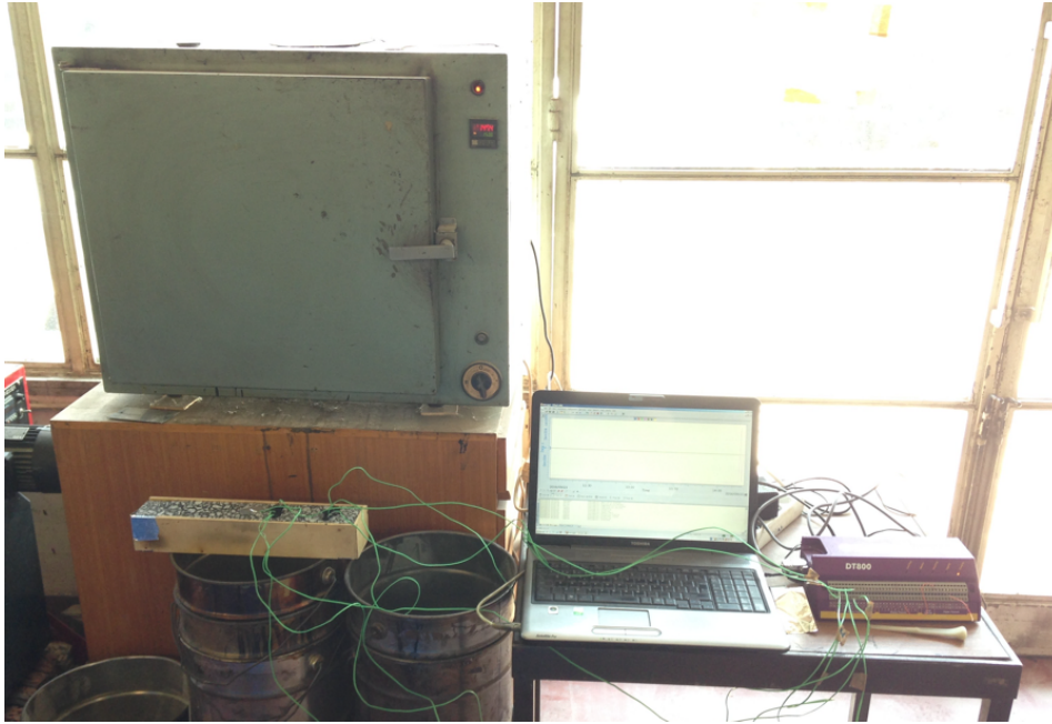
Figura 4.15 - Aquecimento de provetes em estufa
