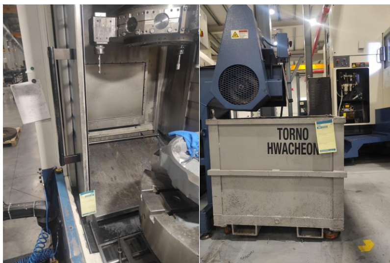
Figura 26 - Problema na porta e no contentor de limalha do Hwacheon
