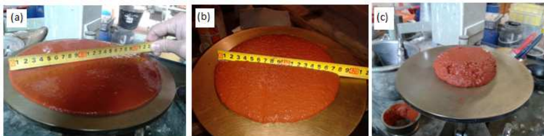
Figura 6: Imagem das argamassas geopoliméricas: (a) G1R1, (b) G1R3, (c) G1R4
