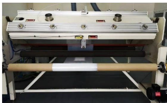
Figura 6. Sigma Technologies International – Atmospheric Plasma Treatment System - Equipamento do CeNTI para o pré-tratamento a nível industrial de substratos têxteis com plasma não térmico à pressão atmosférica.
