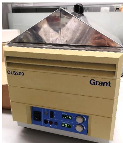
Figura 12. Equipamento Grant OLS200 utilizado para os banhos de esgotamento realizados ao longo deste projeto.
