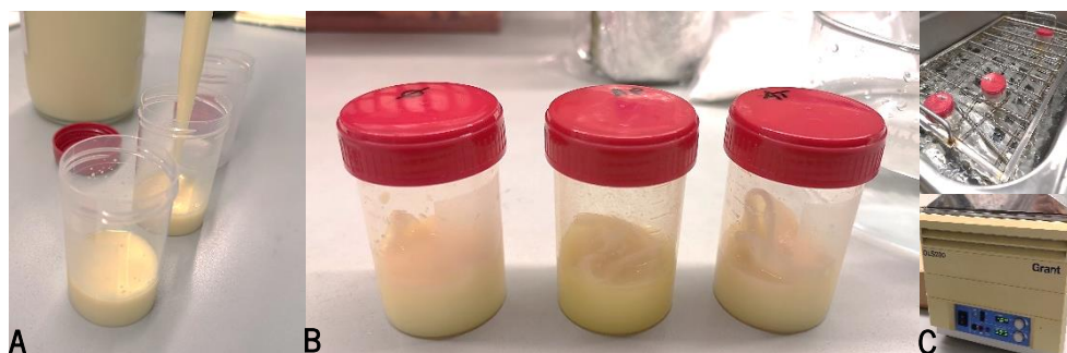
Figura 14. Etapas da biocoloração/funcionalização dos provetes de algodão com própolis. A - Colocação da solução de biocoloração nos copos de esgotamento. B - Adição dos provetes de algodão à solução de biocoloração. C - Banho termostático onde decorre a etapa de esgotamento.
