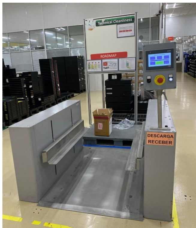
Figura 83: Plataforma do MiR adequada para transportes de europaletes
