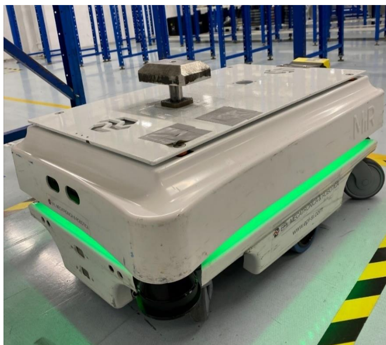
Figura 32: Módulo adaptativo do MiR 100
