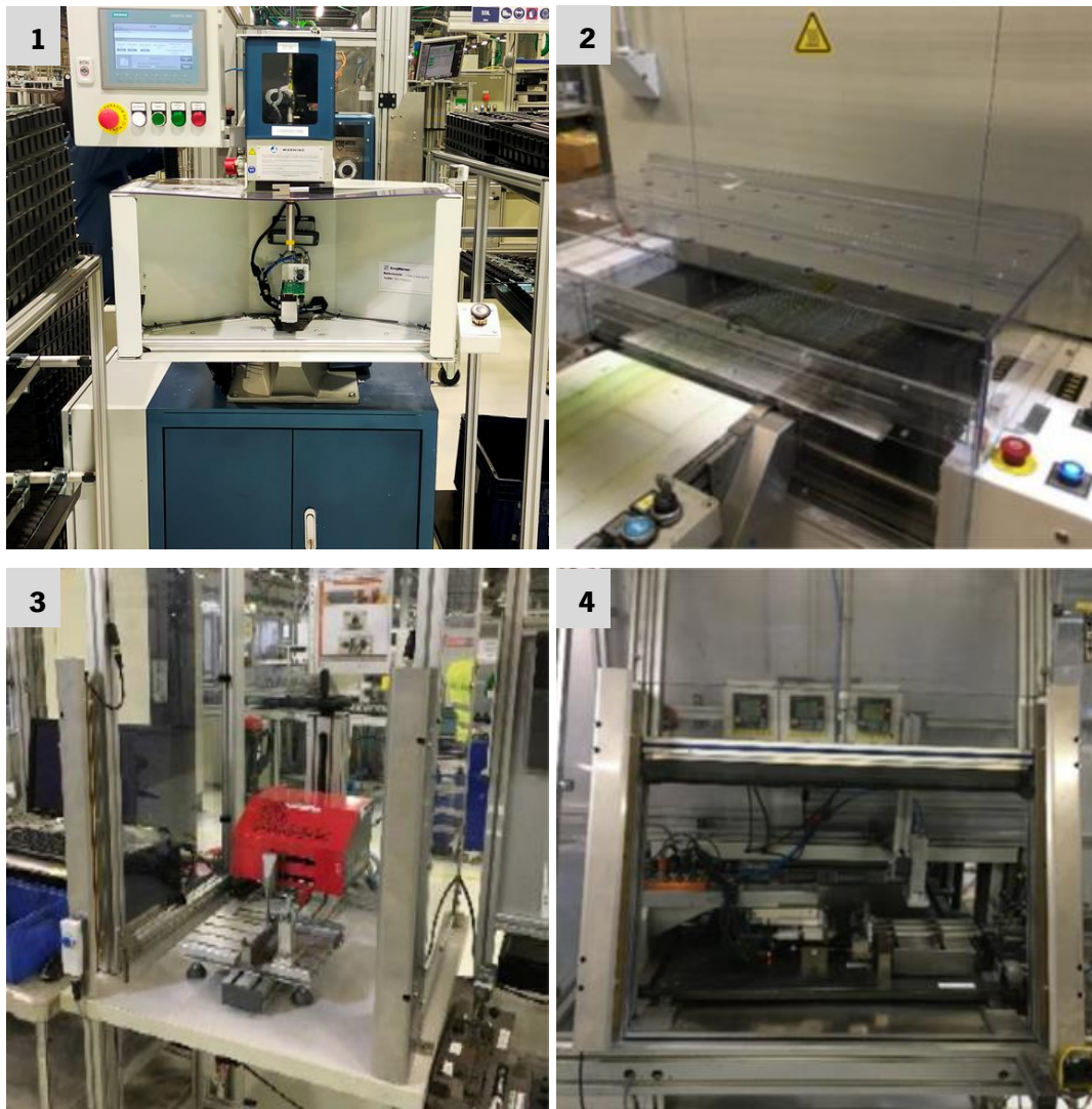
Figura 55: Máquinas após implementação de barreiras de segurança (1- Pressionamento de bolt da linha 7H05-1; 2- Tapete de entrada de rods no forno da linha 7H03-2; 3- Marcação da linha 7H06-1; 4- Laser L2 da linha 7H03-4).
