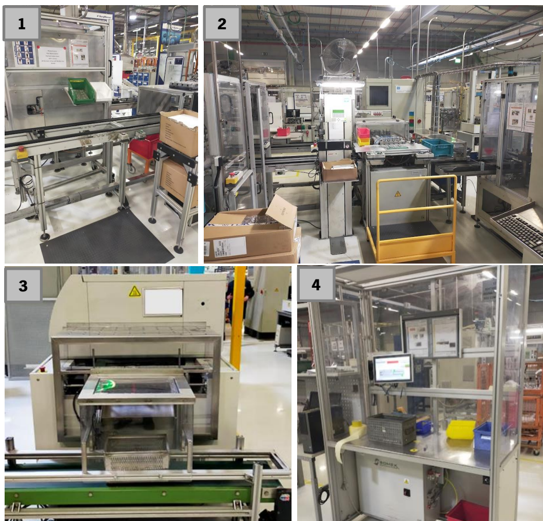
Figura 17: Linha Heater Rods (7H03-2). (1) Posto de montagem de frames no transportador; (2) posto de montagem nos tubos e tapete, (3) posto de saída do forno, (4) posto de controle de qualidade.
