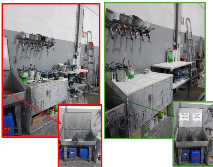
Figura 31 - Aplicação dos primeiros 3S na zona de apoio à pintura.
