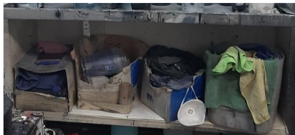
Figura 49 - Fatos de pintura mal armazenados
