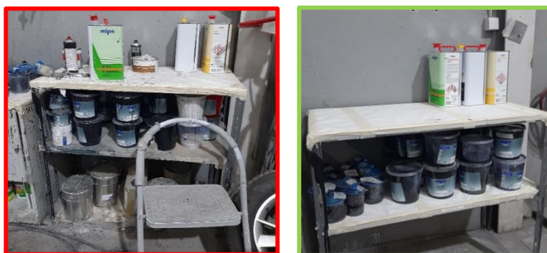
Figura 32 - Intervenção 2S com restos de tintas.
